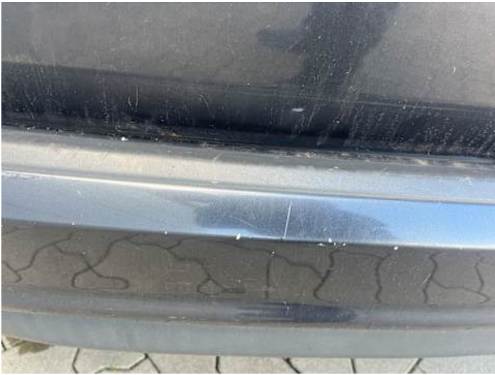
Stoßstange hinten (Kratzer, Lackschaden)
