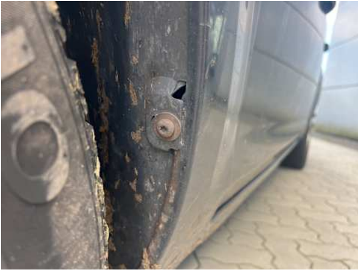
Kotflügel vorne links (Lackschaden, Rost)
