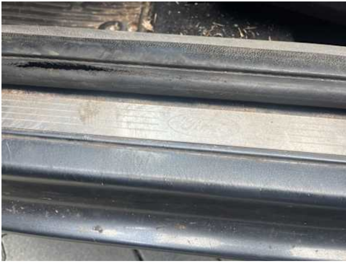
Fahrtür (Kratzer, Lackschaden)
