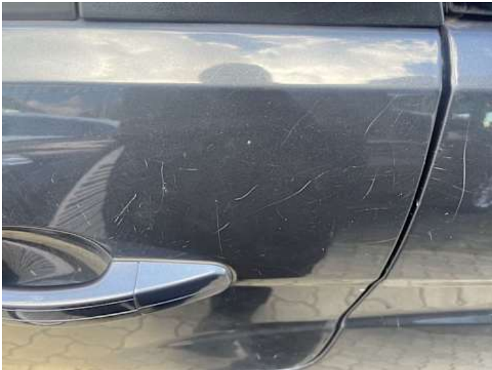
Türe hinten links (Kratzer, Lackschaden)
