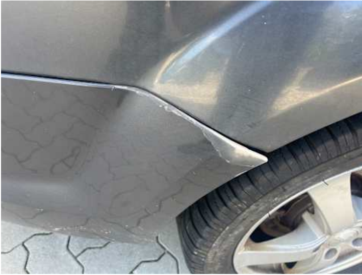
Stoßstange hinten (Spaltmaße ungenau, Lackschaden)
