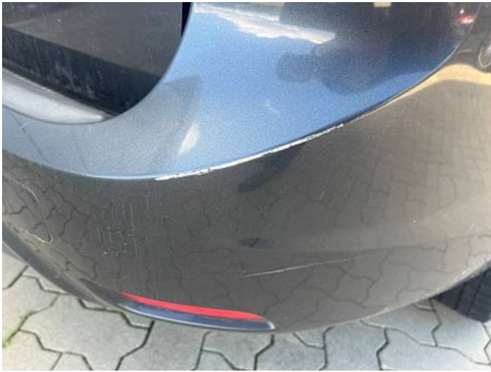
Stoßstange hinten (Kratzer, Lackschaden)
