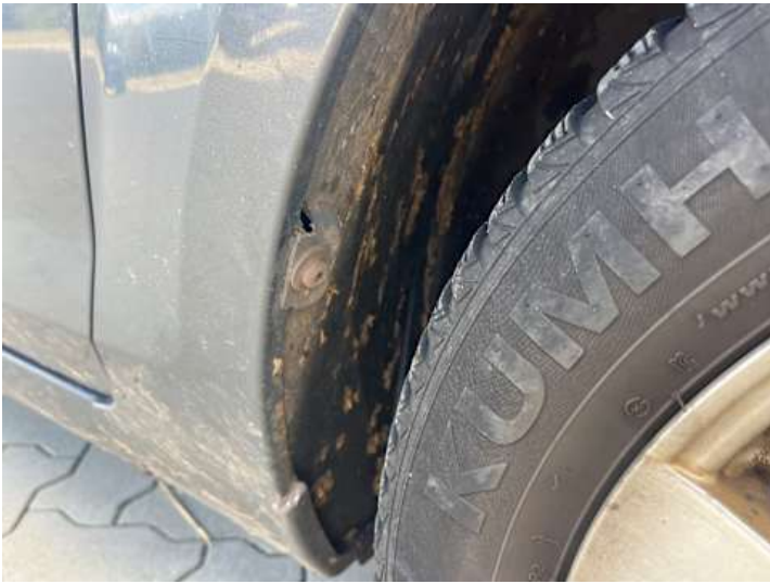
Kotflügel vorne rechts (Lackschaden, Rost)
