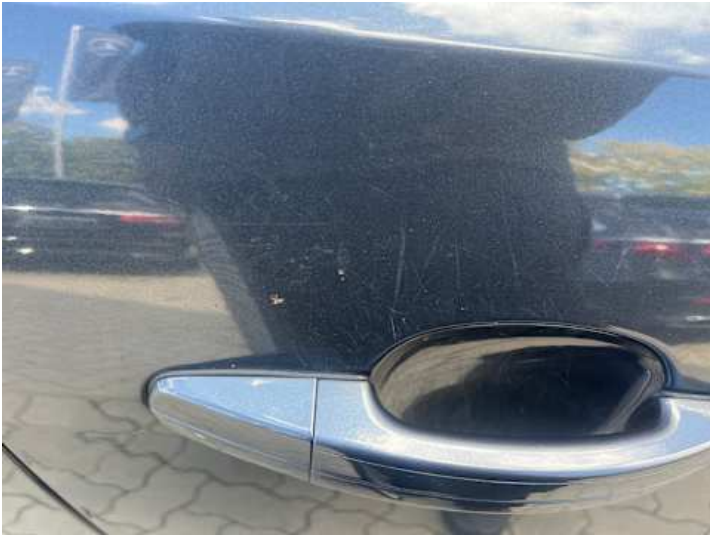
Beifahrtür (Kratzer, Lackschaden)
