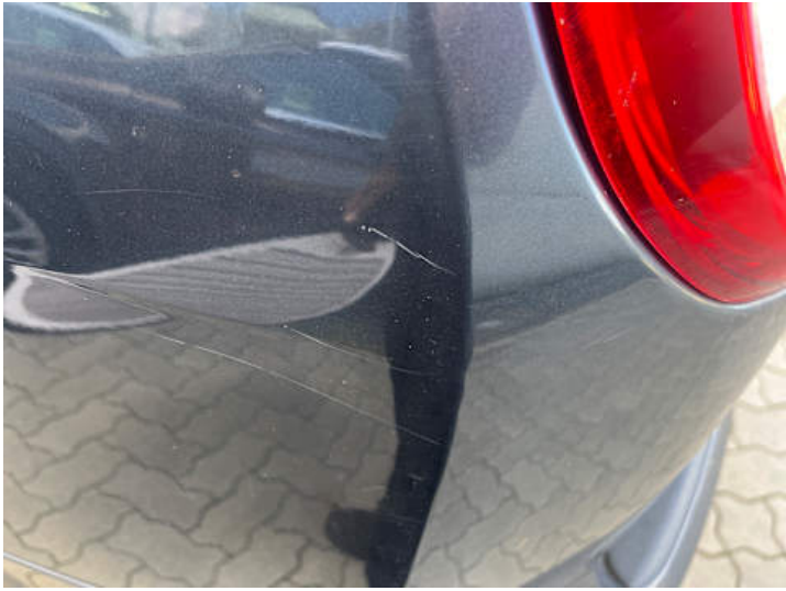
Seitenteil hinten links (Kratzer, Lackschaden)
