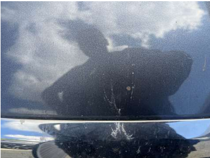
Motorhaube (Lackschaden, Rost)
