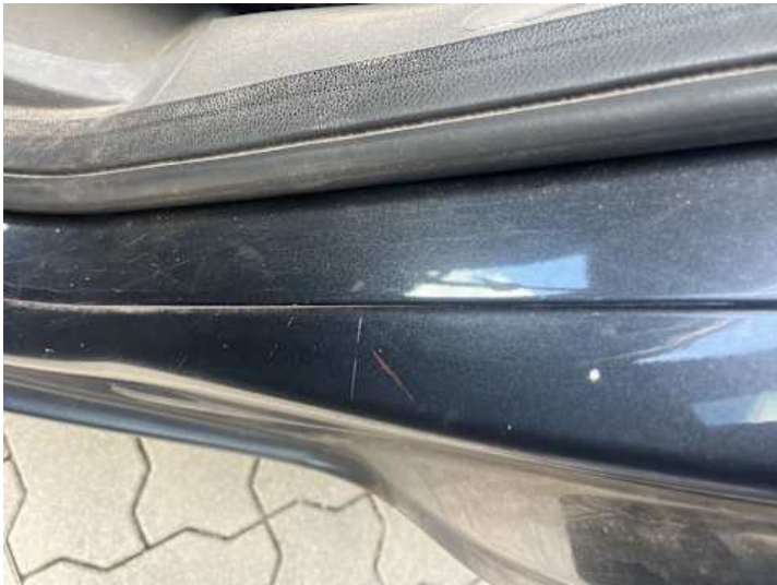
Türe hinten links (Kratzer, Lackschaden)
