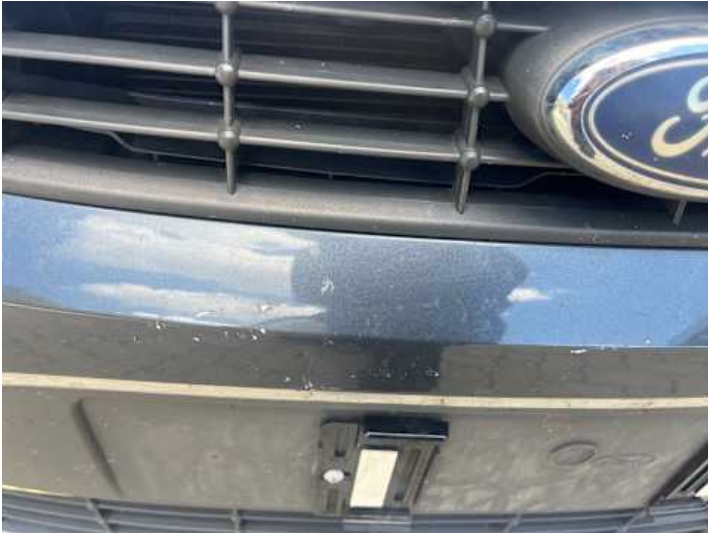
Stoßstange vorne (Kratzer, Lackschaden)
