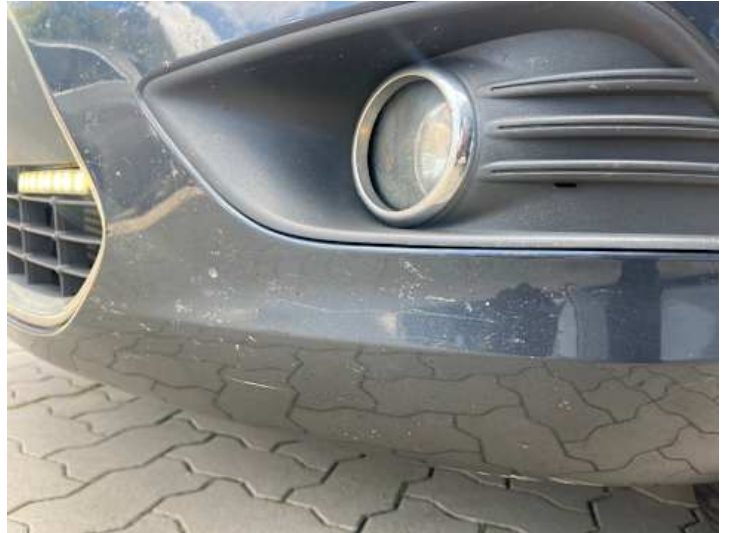
Stoßstange vorne (Kratzer, Lackschaden)
