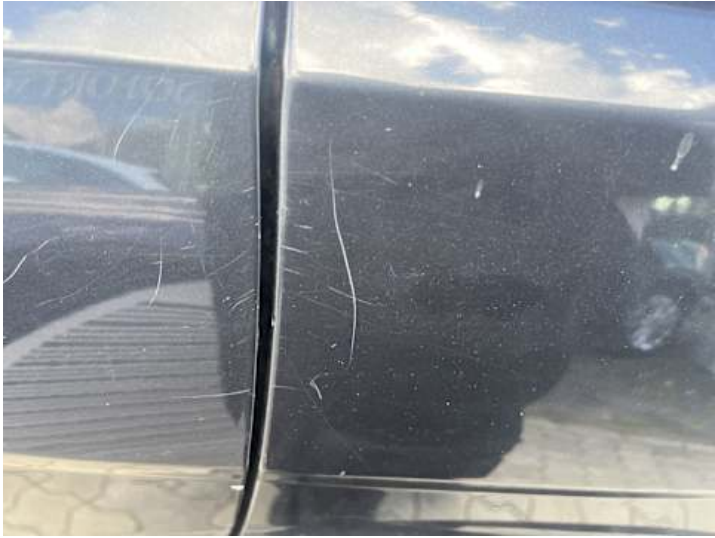
Seitenteil hinten links (Kratzer, Lackschaden)
