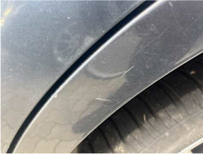
Seitenteil hinten links (Kratzer, Lackschaden)
