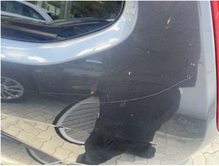
Seitenteil hinten links (Kratzer, Lackschaden)
