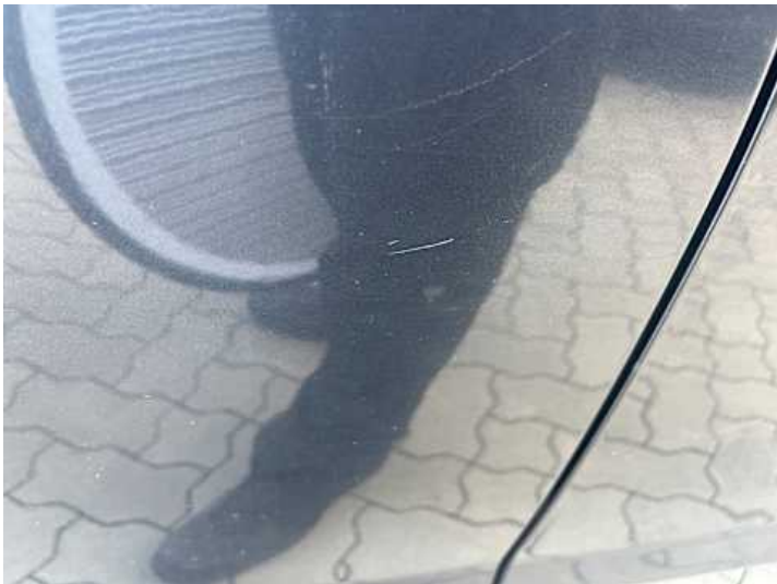
Türe hinten rechts (Kratzer, Lackschaden)
