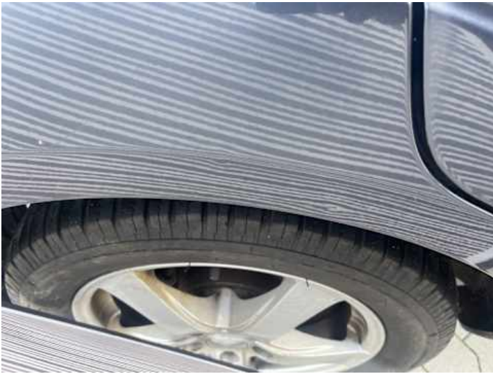
Seitenteil hinten rechts (Delle)
