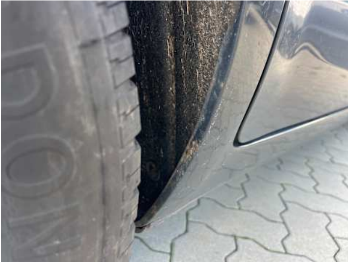
Seitenteil hinten rechts (Lackschaden, Rost)
