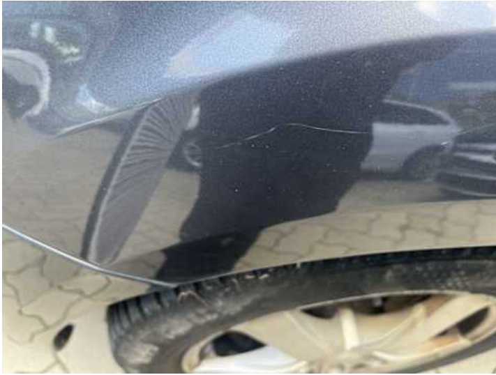
Kotflügel vorne links (Kratzer, Lackschaden)
