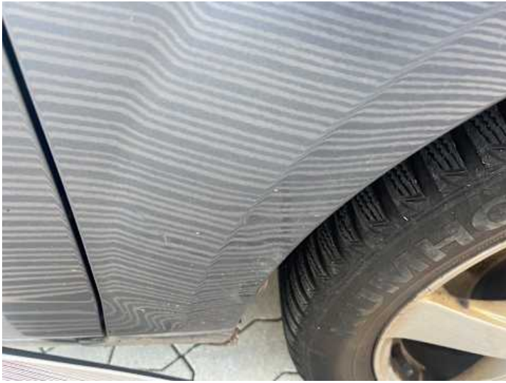
Kotflügel vorne rechts (Delle)
