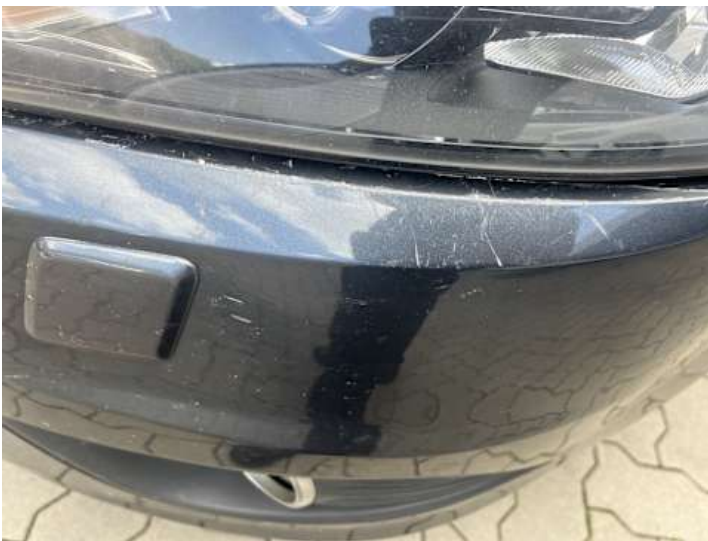
Stoßstange vorne (Kratzer, Lackschaden)
