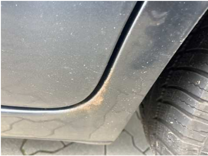
Seitenteil hinten links (Lackschaden, Rost)
