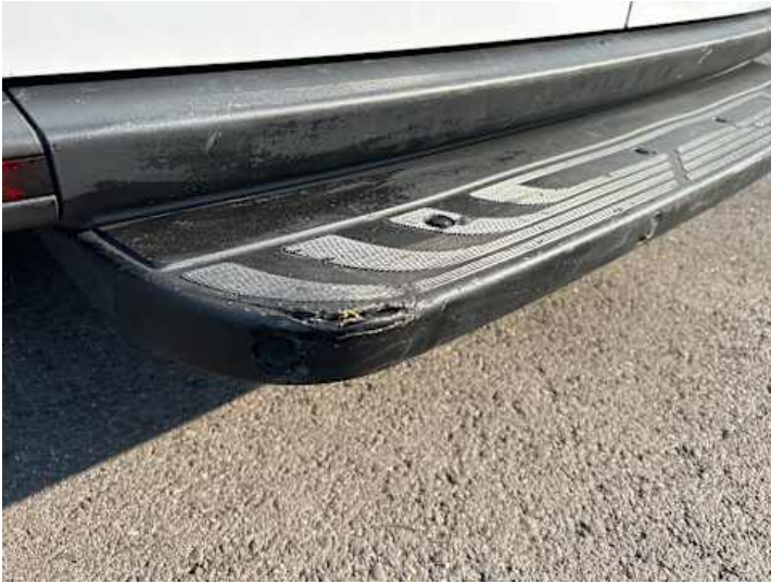
Stoßstange hinten (Kratzer, Riss/Bruch)
