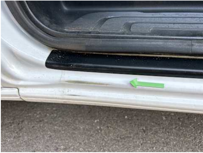
Schweller links (Kratzer)
