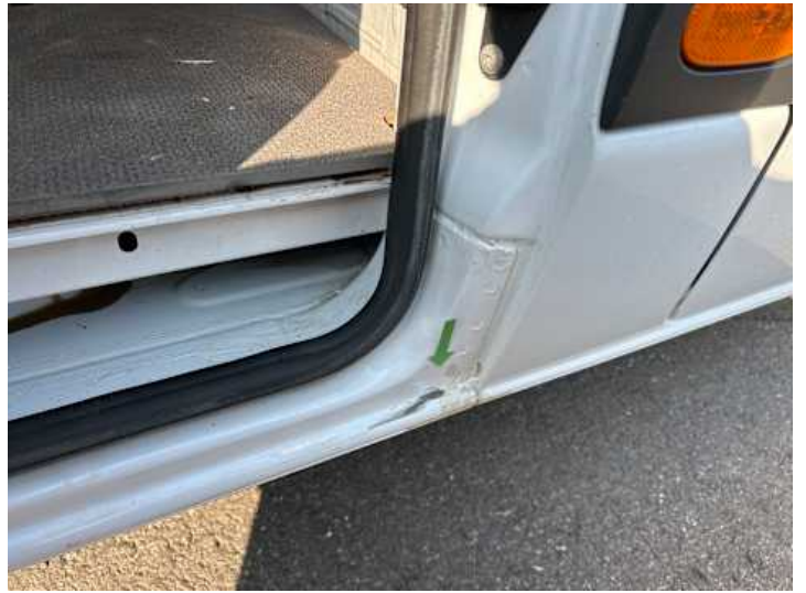
Schweller rechts (Lackschaden)
