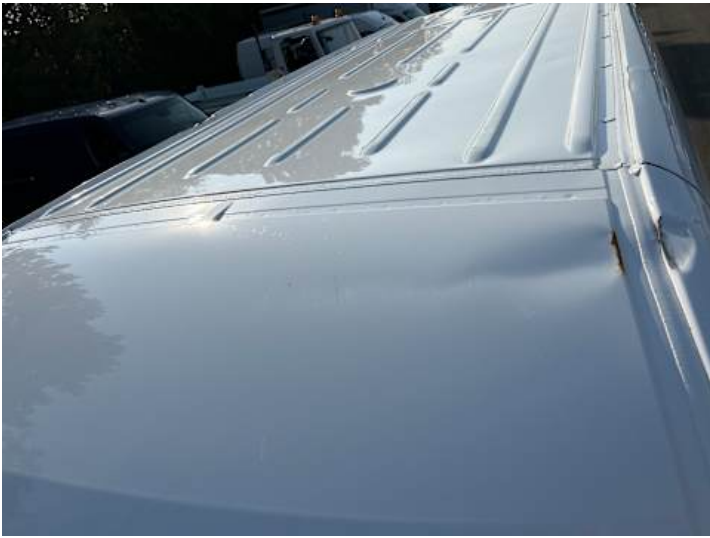
Dach (Verformung, Kratzer, Rost)
