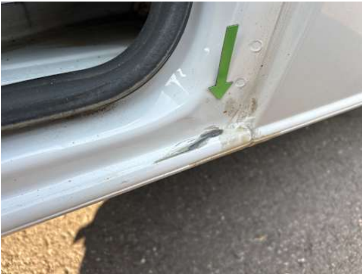
Schweller rechts (Lackschaden)
