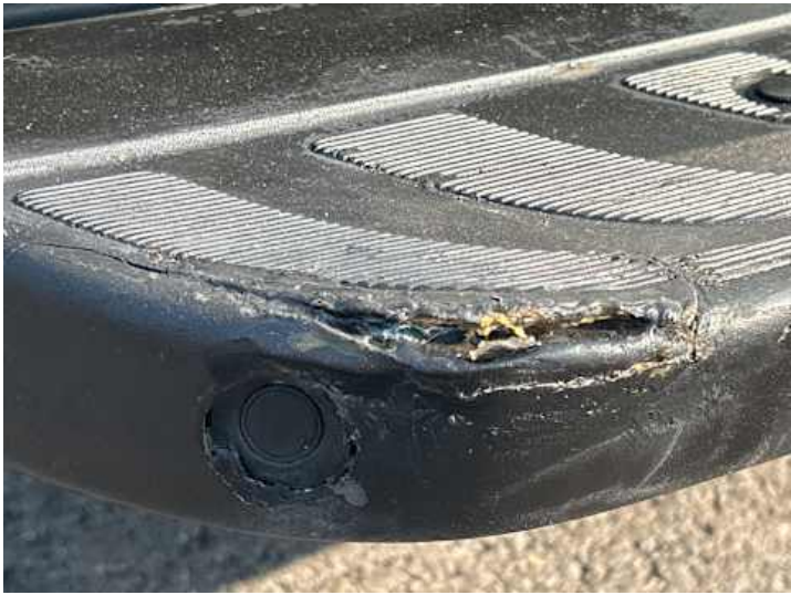
Stoßstange hinten (Kratzer, Riss/Bruch)
