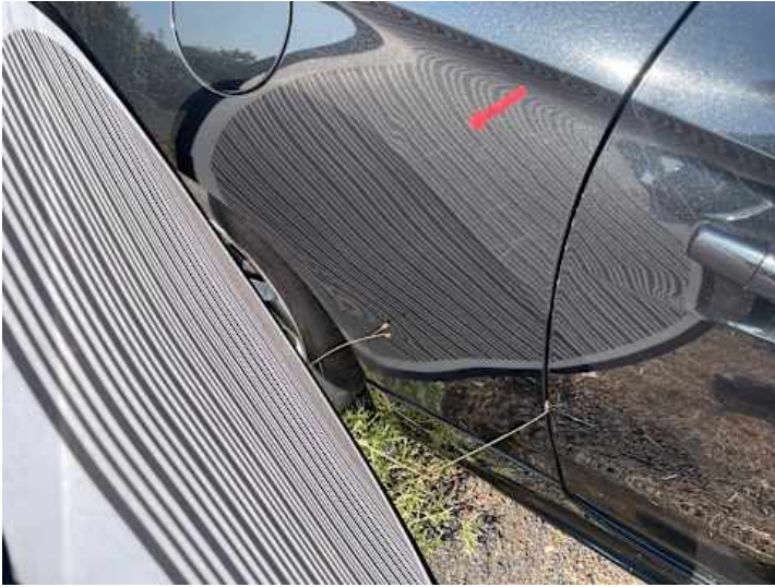
Seitenteil hinten rechts (Verformung)
