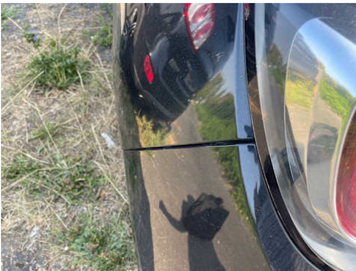
Stoßstange hinten (Spaltmaße ungenau)
