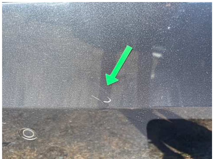
Stoßstange hinten (Kratzer, Lackschaden)
