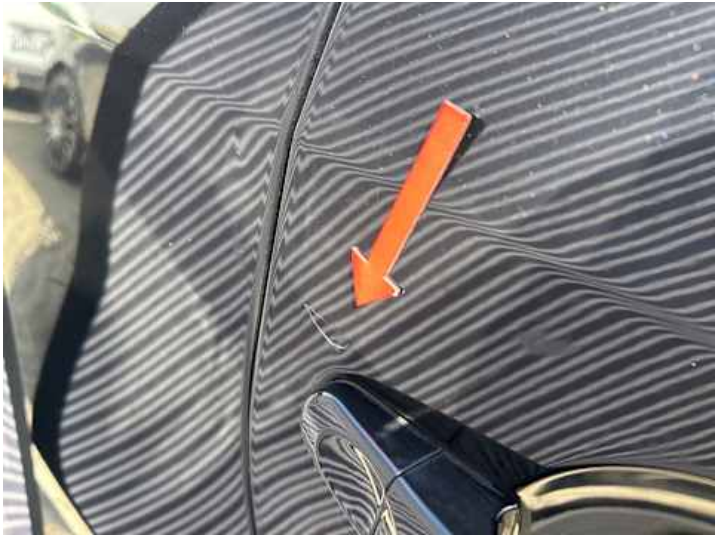
Türe hinten rechts (Lackschaden, Verformung)
