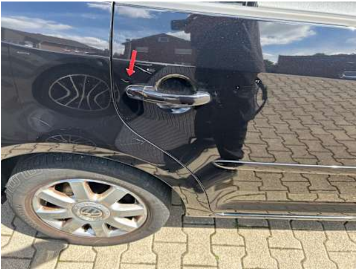
Türe hinten rechts (Lackschaden, Verformung)
