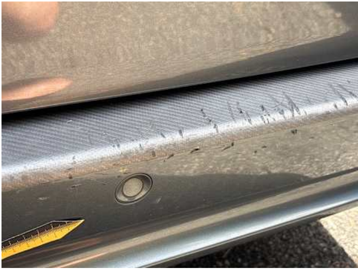
Stoßstange hinten (Kratzer, Lackschaden)
