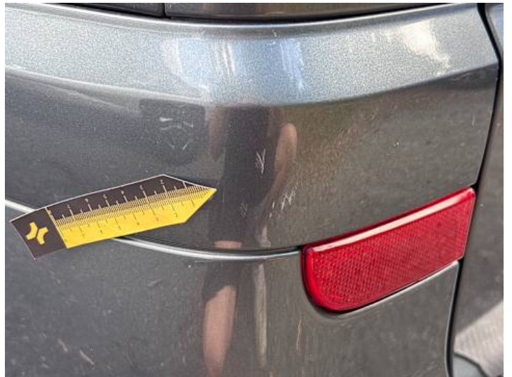
Stoßstange hinten (Kratzer, Lackschaden)
