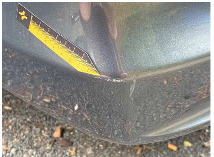
Stoßstange hinten (Kratzer, Lackschaden)
