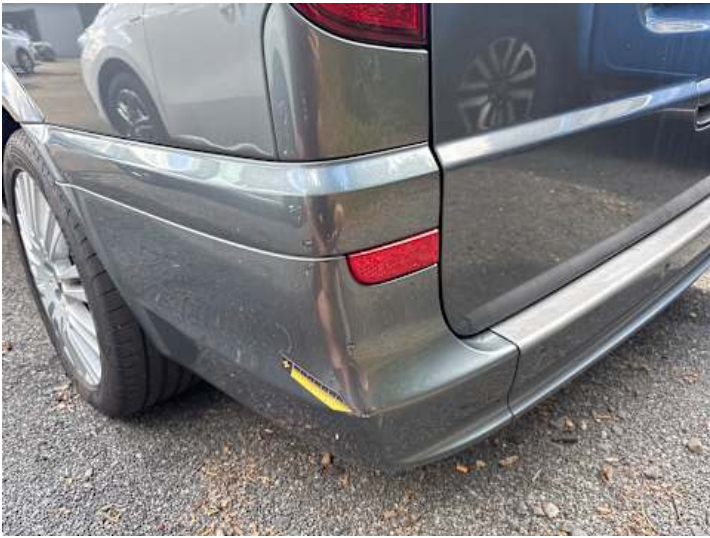
Stoßstange hinten (Kratzer, Lackschaden)
