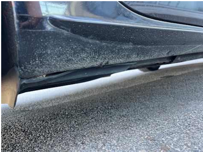
Schweller rechts (Rost)
