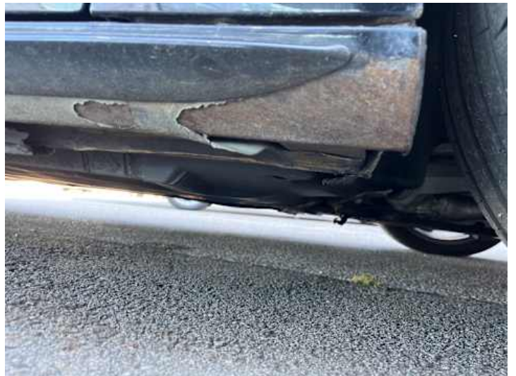
Schweller rechts (Rost)
