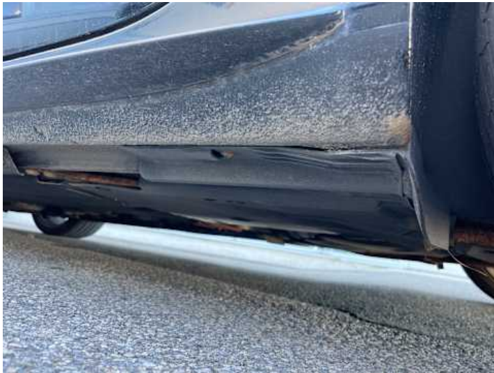
Schweller links (Rost)
