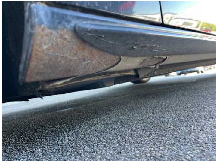
Schweller links (Rost)
