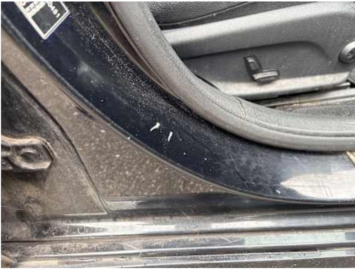
Schweller rechts (Kratzer)
