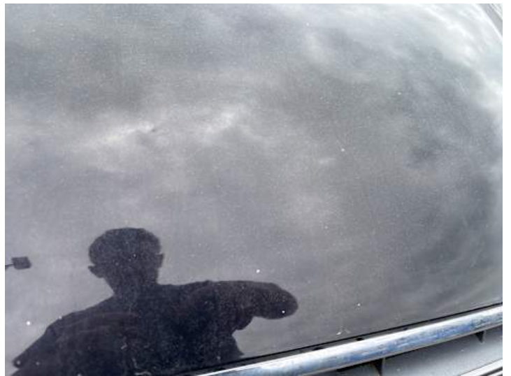
Motorhaube (Anderer Schaden): Mehrere Steinschläge auf der Oberfläche
