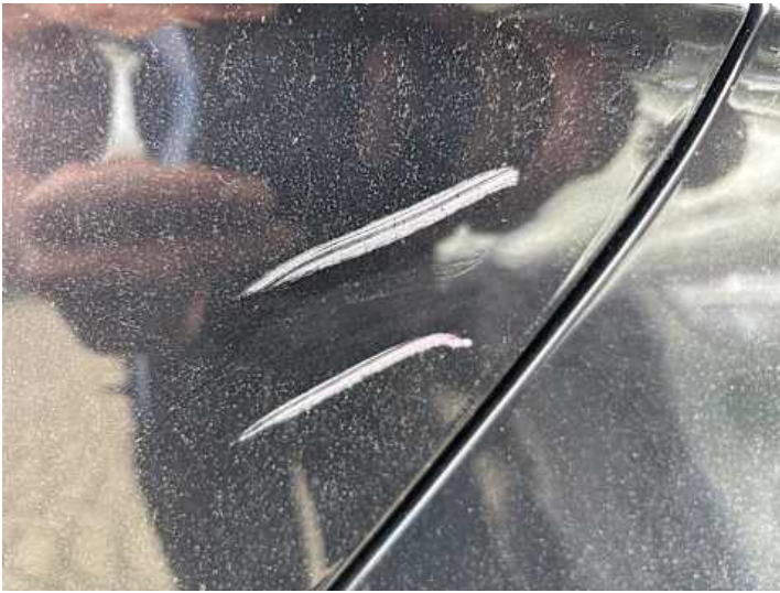
Türe hinten links (Unsachgemäß instand gesetzt, Kratzer)
