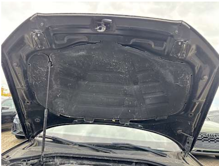
Motorhaube (Anderer Schaden): Dämmung beschädigt
