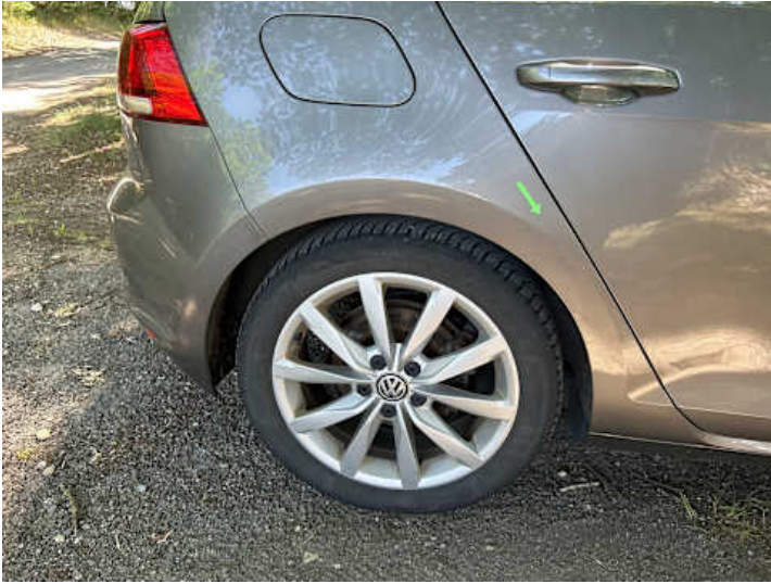
Seitenteil hinten rechts (Delle, Kratzer)
