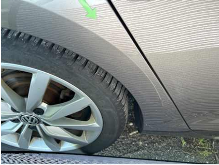
Seitenteil hinten rechts (Delle, Kratzer)
