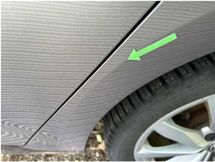
Seitenteil hinten links (Delle)
