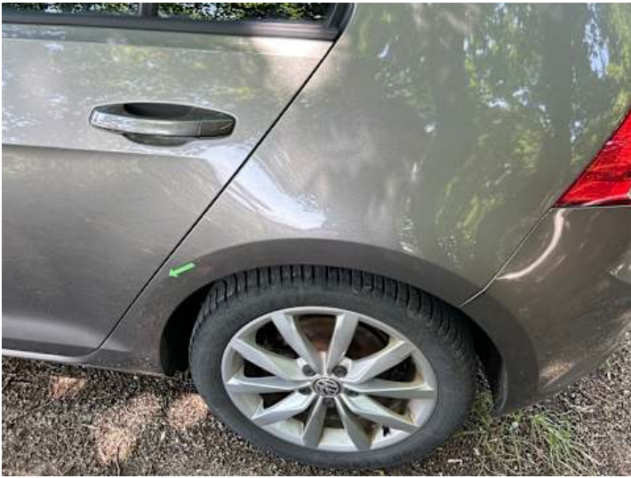
Seitenteil hinten links (Delle)
