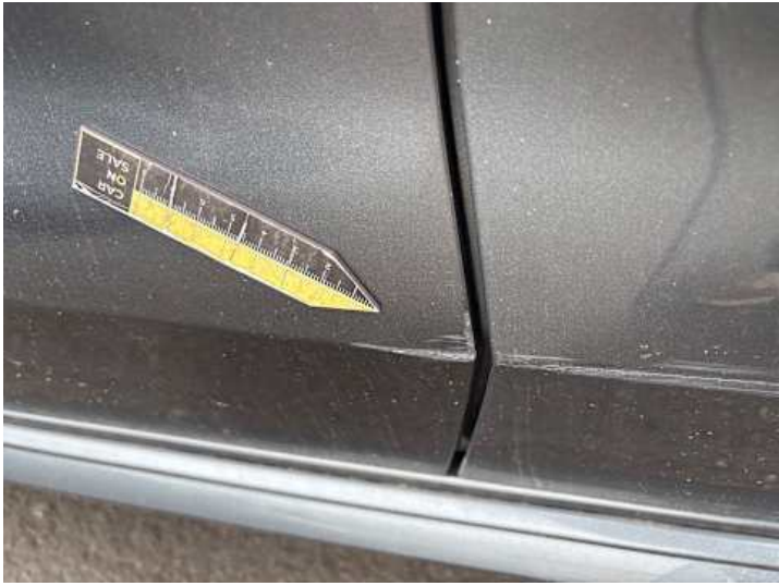
Türe hinten rechts (Kratzer, Verformung)
