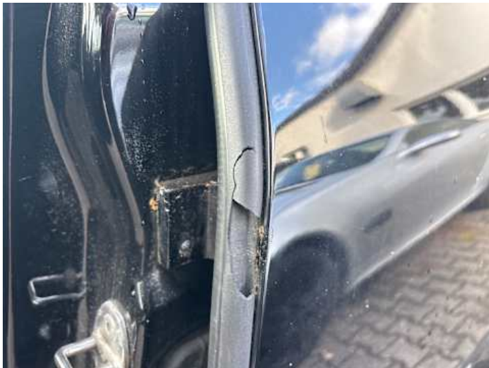
Türe hinten links (Anderer Schaden, Riss/Bruch): Dichtung
