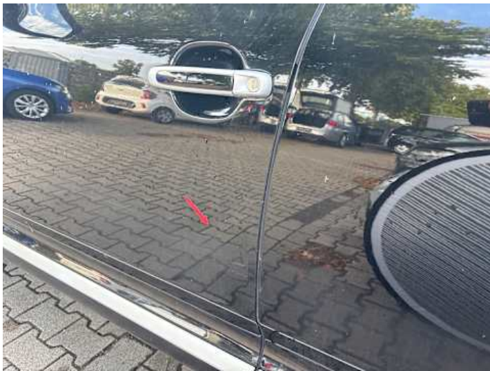
Fahrertür (Lackschaden, Verformung)
