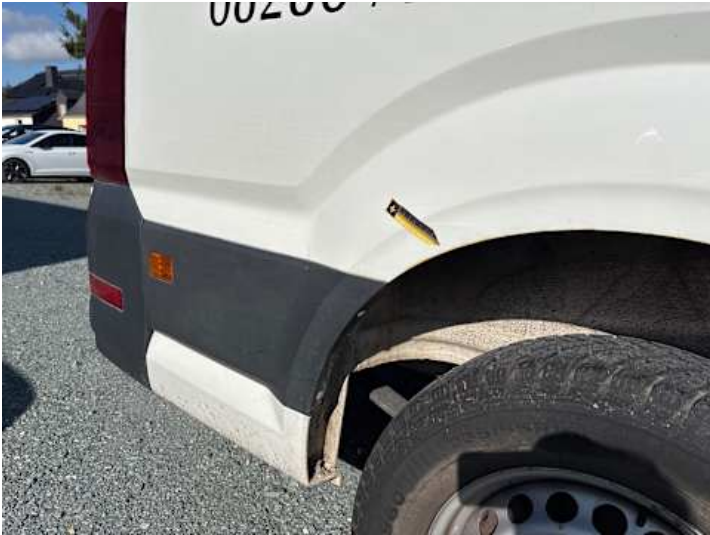
Seitenteil hinten rechts (Lackschaden, Rost)
