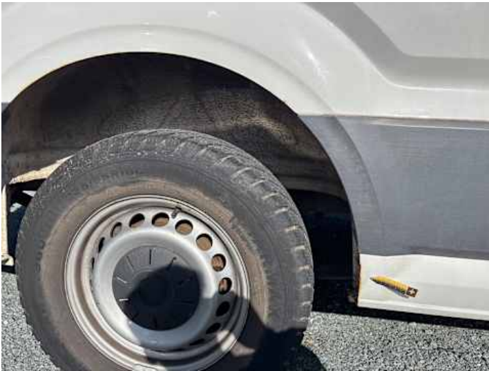
Seitenteil hinten rechts (Lackschaden, Rost)
