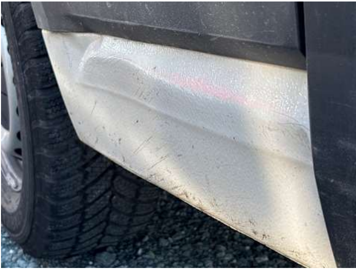
Seitenteil hinten links (Delle, Verformung)
