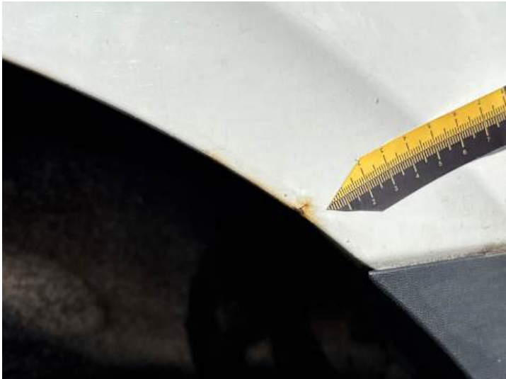
Seitenteil hinten rechts (Lackschaden, Rost)
