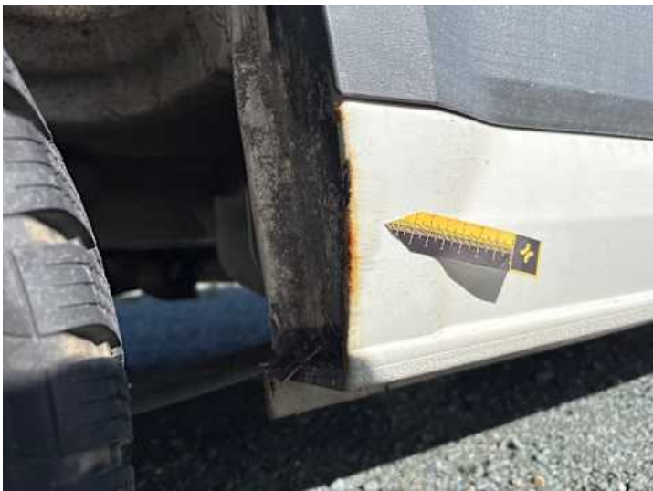
Seitenteil hinten rechts (Lackschaden, Rost)
