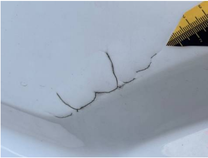
Seitenteil hinten links (Unsachgemäß instand gesetzt, Lackschaden, Riss/Bruch)
