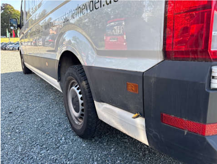
Seitenteil hinten links (Delle, Verformung)
