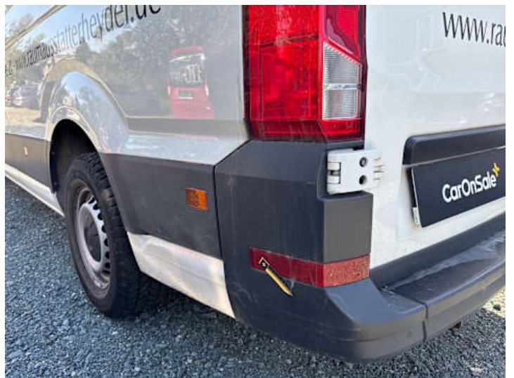
Stoßstange hinten (Kratzer, Verformung)
