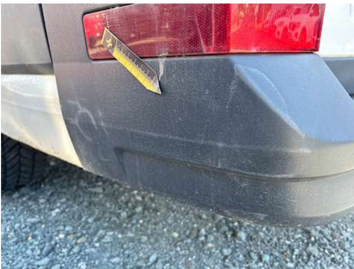
Stoßstange hinten (Kratzer, Verformung)
