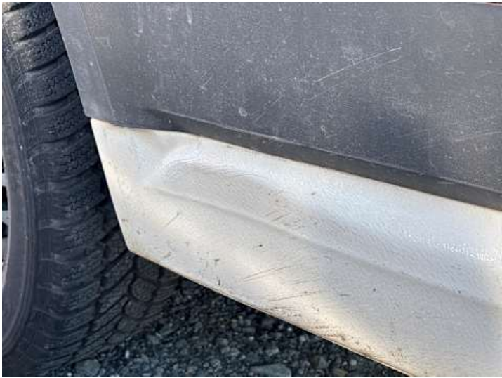
Seitenteil hinten links (Delle, Verformung)
