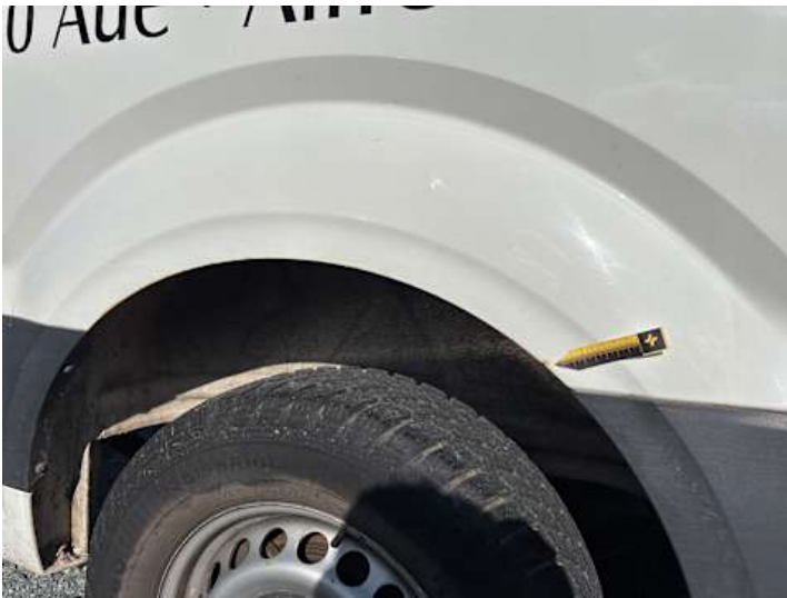
Seitenteil hinten rechts (Lackschaden, Rost)
