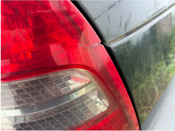
Rücklicht (links) (Riss/Bruch)
