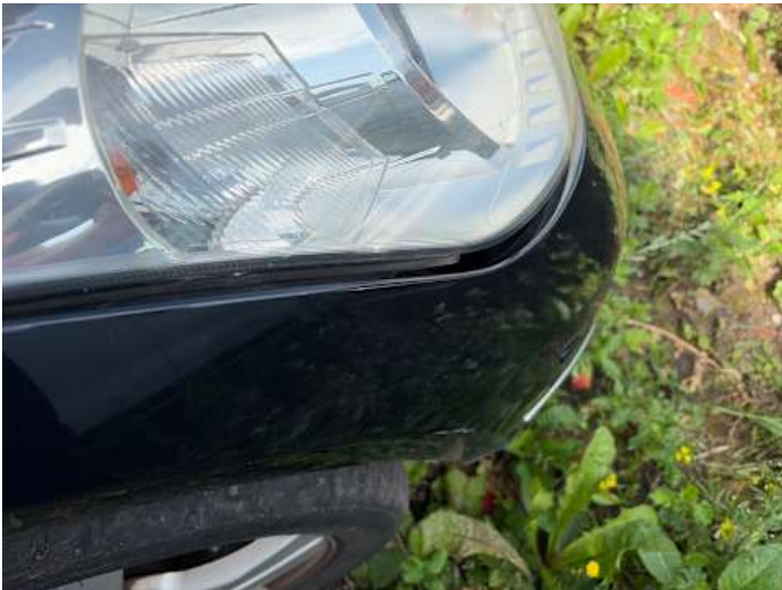
Stoßstange vorne (Kratzer, Spaltmaße ungenau)
