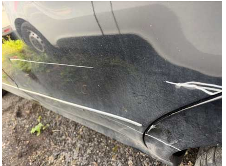
Türe hinten links (Lackschaden, Anderer Schaden): Unfall Schaden
