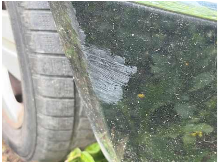
Stoßstange vorne (Kratzer, Spaltmaße ungenau)
