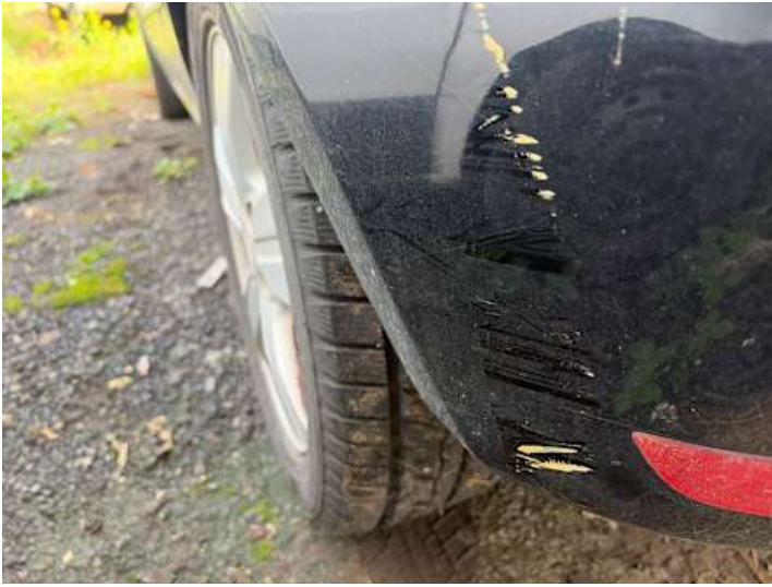
Stoßstange hinten (Kratzer, Lackschaden)
