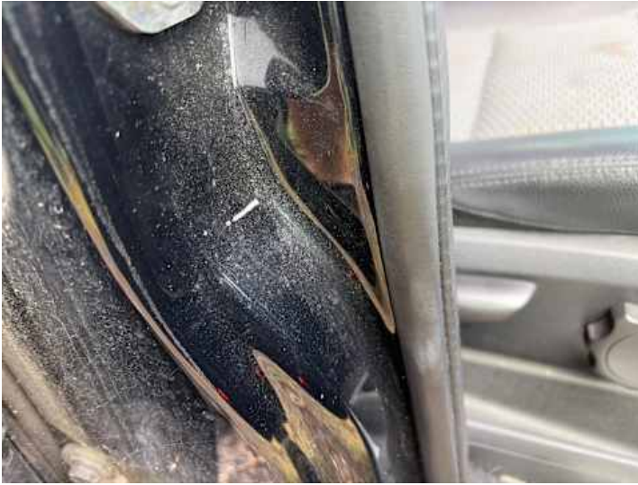
Schweller rechts (Lackschaden)
