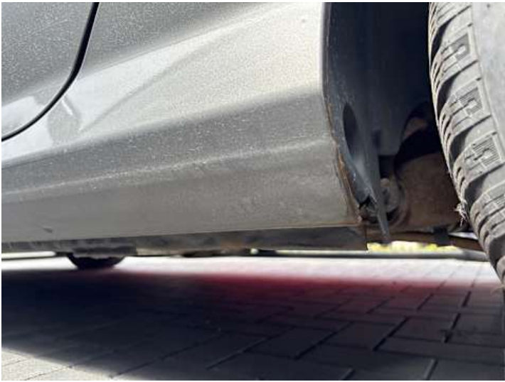
Schweller links (Rost)
