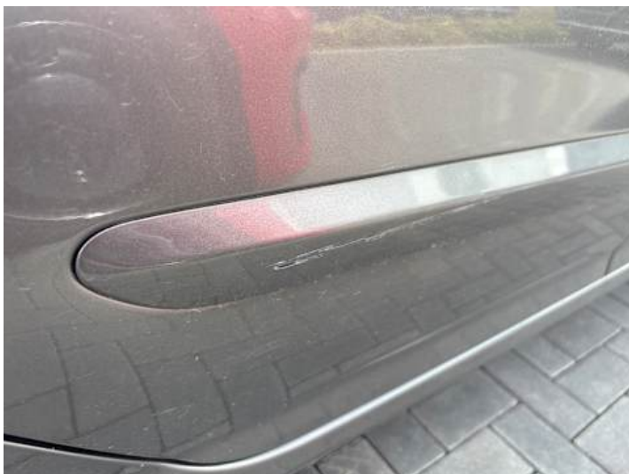
Türe hinten rechts (Kratzer, Lackschaden)
