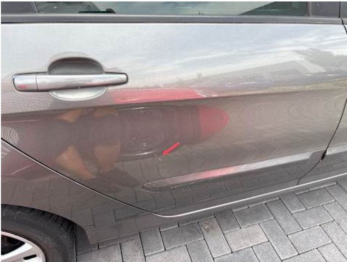
Türe hinten rechts (Kratzer, Lackschaden)
