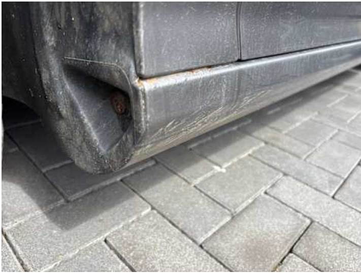
Schweller links (Rost)
