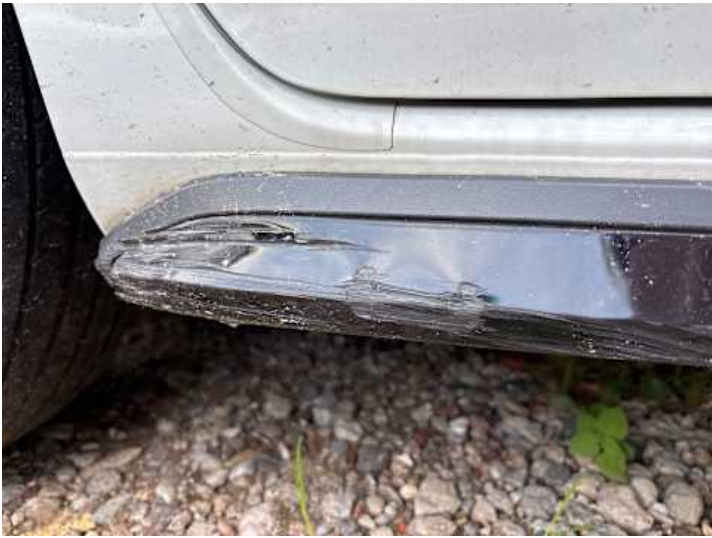
Schweller rechts (Kratzer)
