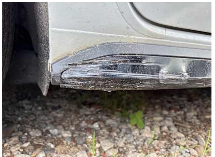
Schweller rechts (Kratzer)
