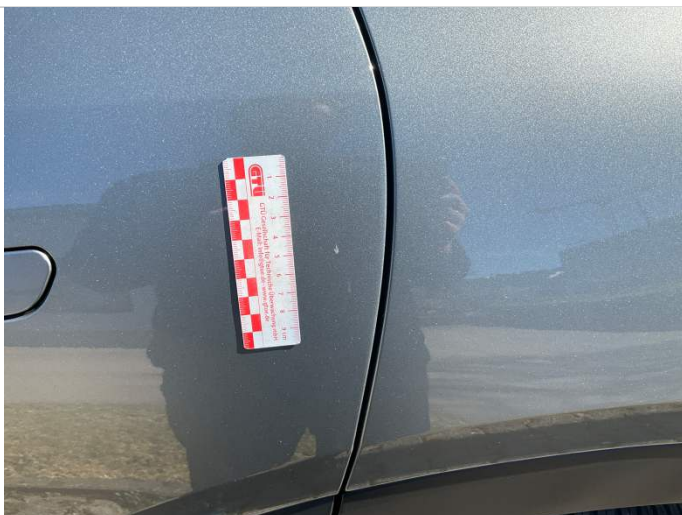
Türe hinten links Lackbeschädigung
