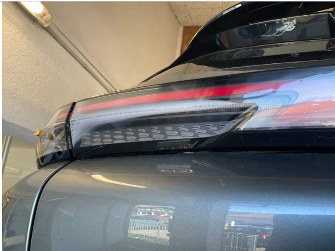
Heckleuchte links und rechts Feuchtigkeit im Glas
