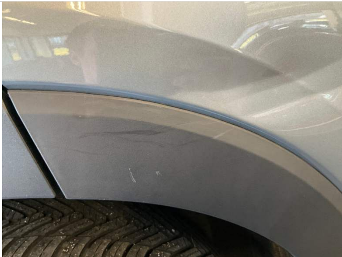
Türblende hinten rechts Kratzer
