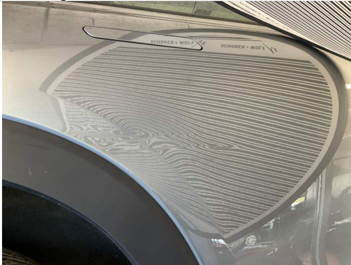
Türe hinten rechts deformiert
