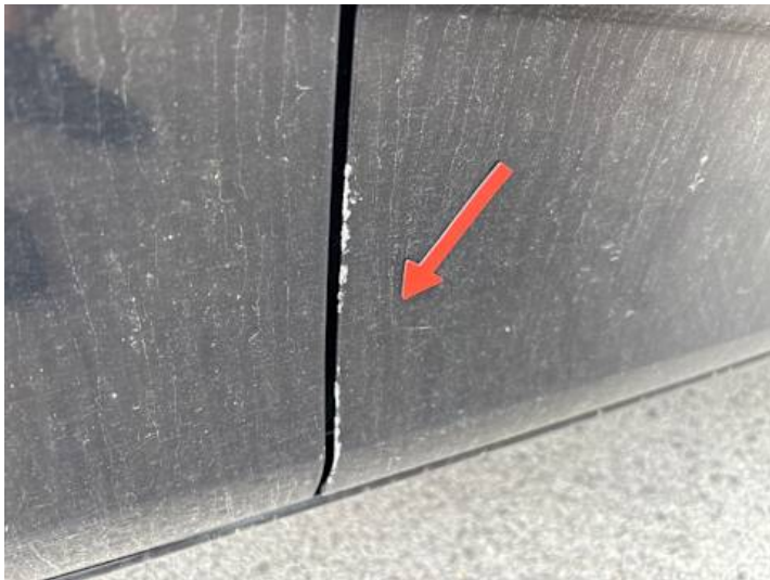
Beifahrtür (Kratzer, Lackschaden)
