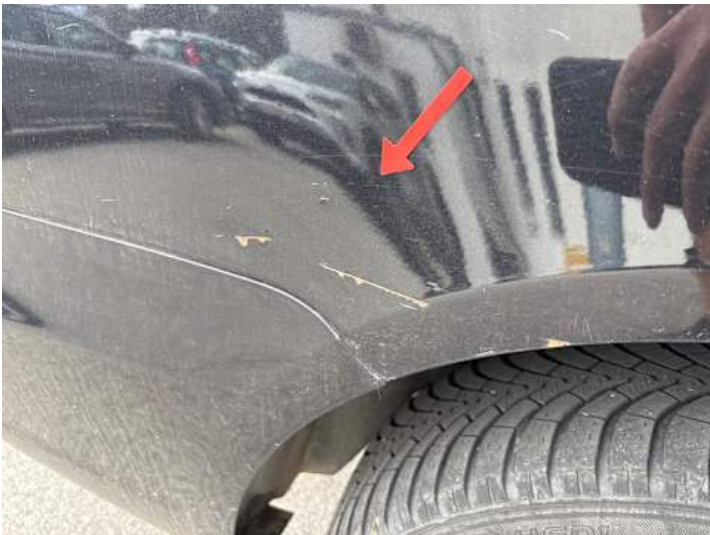
Seitenteil hinten rechts (Kratzer, Lackschaden, Rost)
