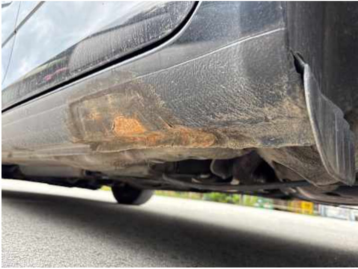
Schweller links (Rost)
