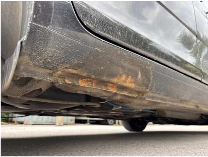
Schweller rechts (Rost)
