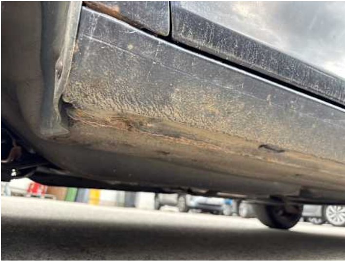
Schweller links (Rost)
