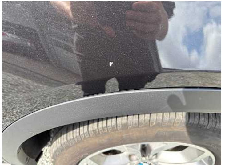
Kotflügel vorne rechts (Lackschaden)
