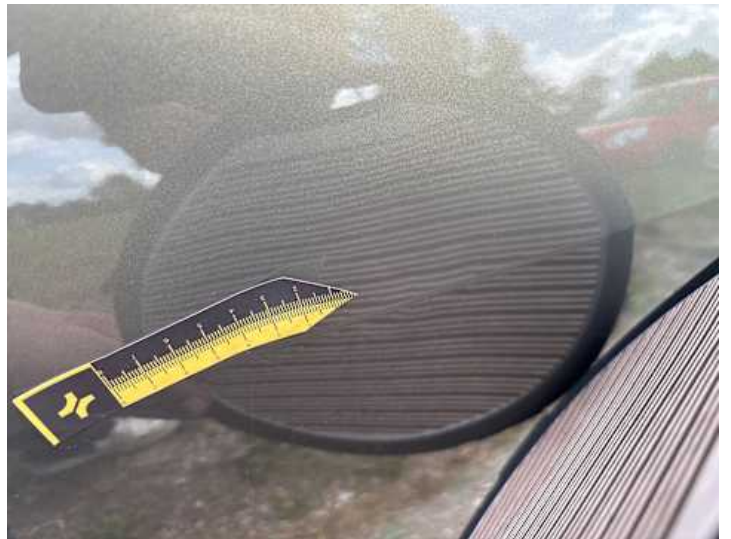
Beifahrertür (Delle, Verformung)
