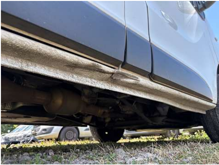
Schweller rechts (Verformung, Kratzer, Lackschaden)
