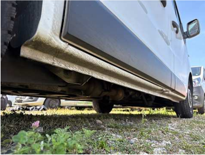
Schweller rechts (Verformung, Kratzer, Lackschaden)
