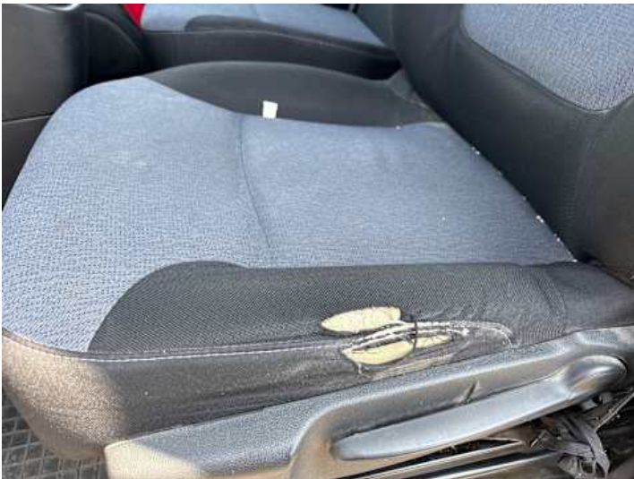
Innenraum (Verschleiß, Riss/Bruch)
