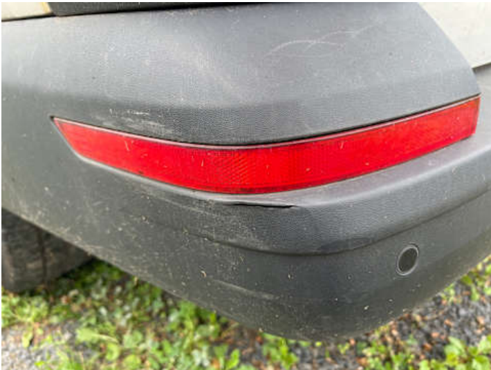
Stoßstange hinten (Verformung, Riss/Bruch)
