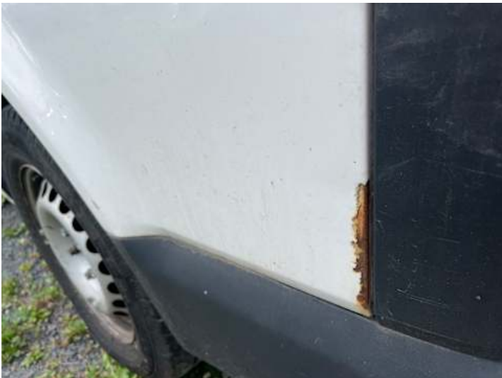
Seitenteil hinten links (Rost, Kratzer)
