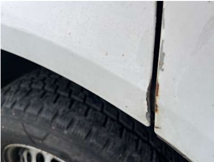
Kotflügel vorne links (Kratzer, Rost)
