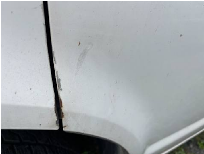
Fahrtür (Kratzer, Rost)
