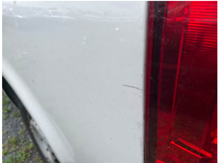
Seitenteil hinten links (Rost, Kratzer)
