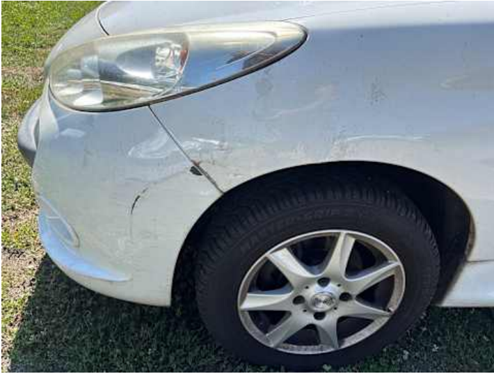
Kotflügel vorne links (Delle, Rost, Lackschaden)
