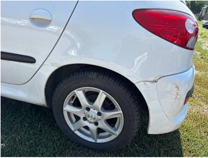
Seitenteil hinten links (Verformung, Kratzer, Lackschaden)
