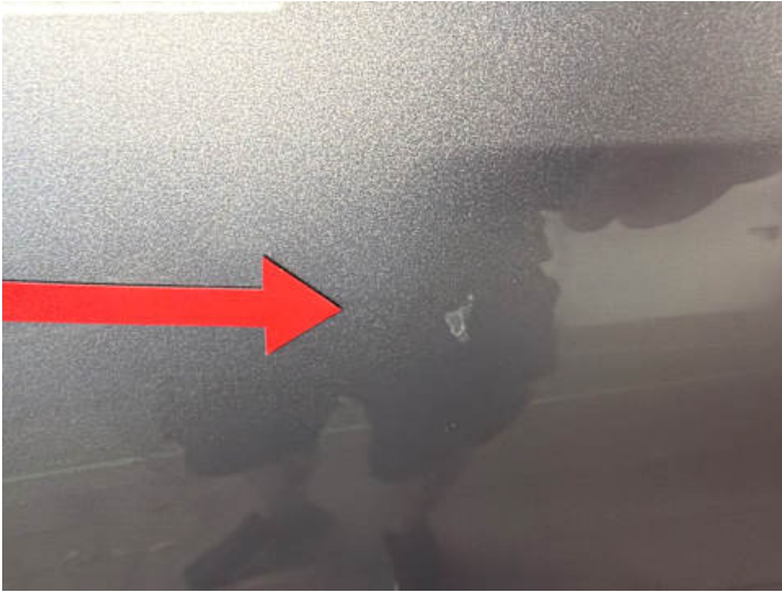
Türe hinten rechts (Lackschaden, Kratzer)
