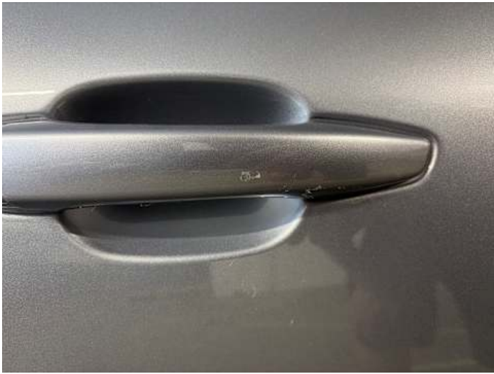
Beifahrertür (Kratzer, Lackschaden)
