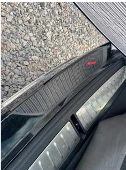
Stoßstange hinten (Unsachgemäß instand gesetzt)
