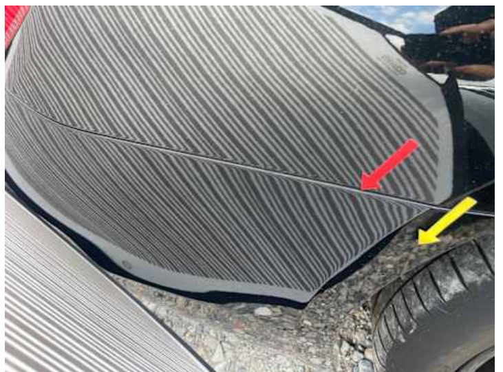
Stoßstange hinten (Unsachgemäß instand gesetzt)
