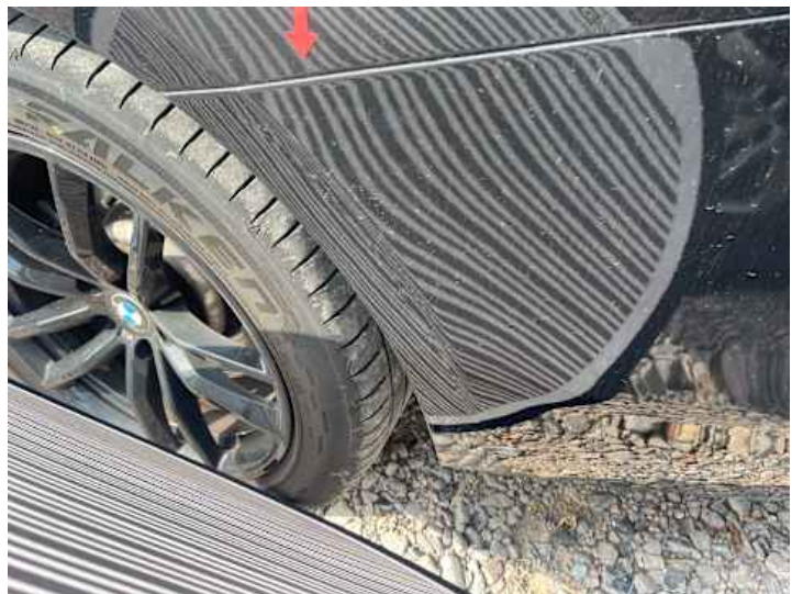
Stoßstange hinten (Unsachgemäß instand gesetzt)
