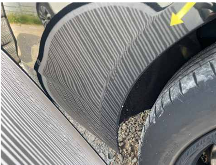
Stoßstange hinten (Unsachgemäß instand gesetzt)
