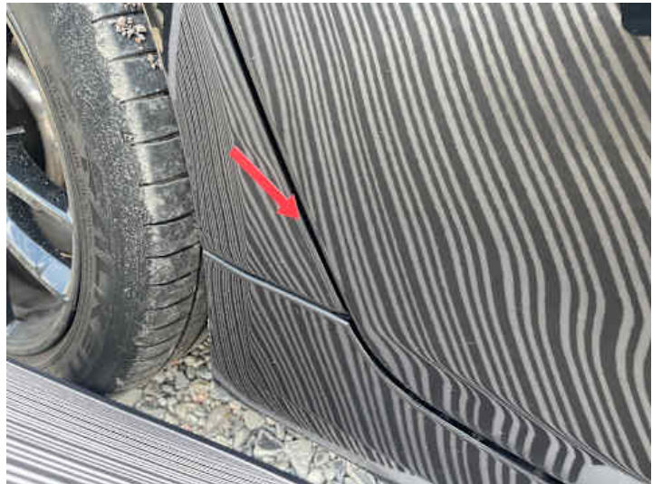
Türe hinten rechts (Unsachgemäß instand gesetzt)
