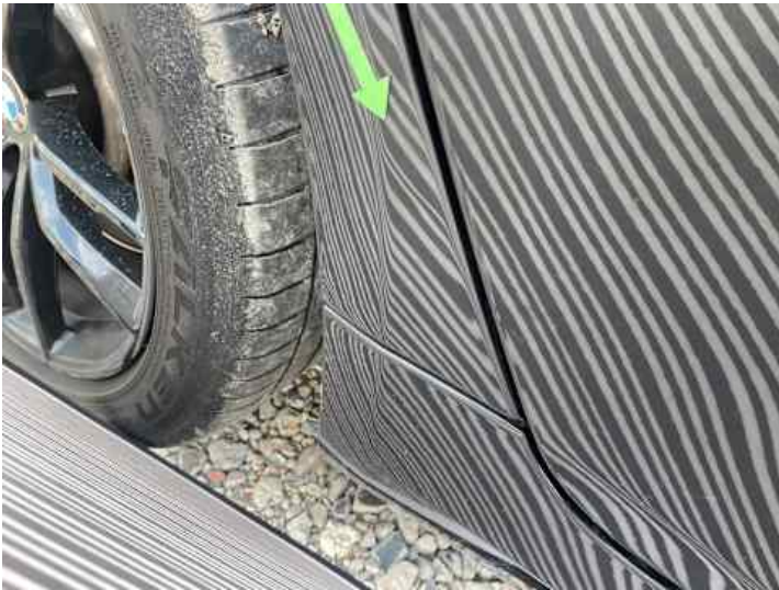
Seitenteil hinten rechts (Unsachgemäß instand gesetzt)
