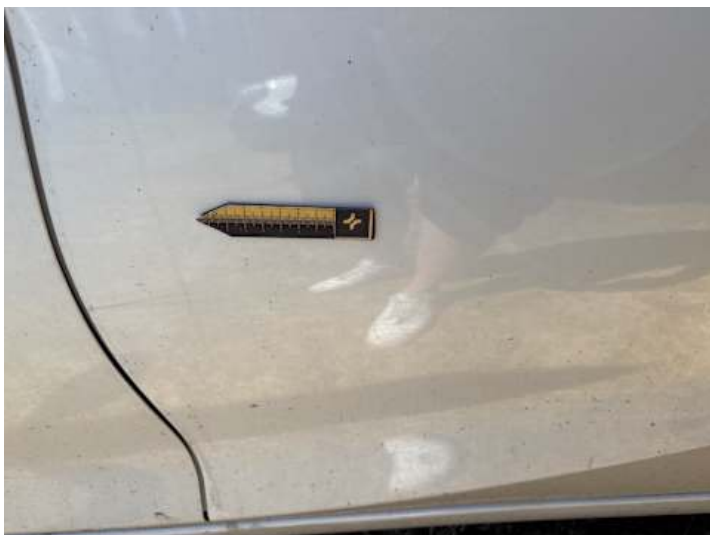
Türe hinten links (Kratzer)
