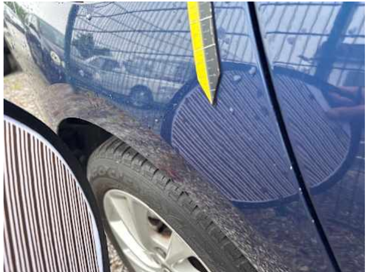
Seitenteil hinten rechts (Delle)
