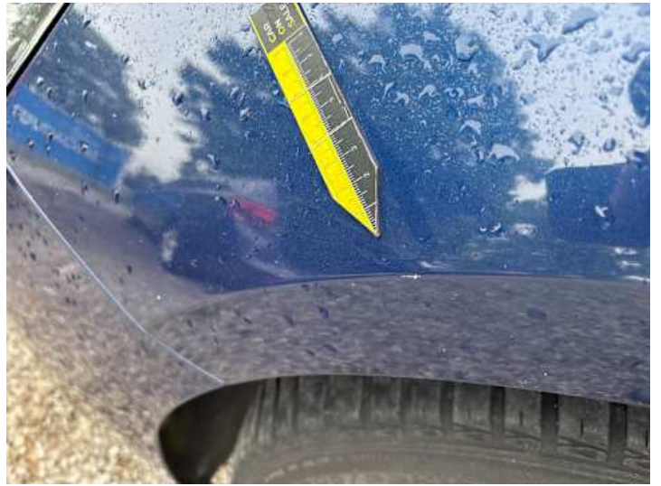
Kotflügel vorne links (Kratzer)
