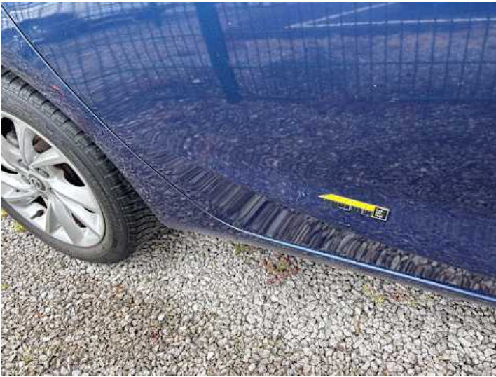
Türe hinten rechts (Delle, Kratzer)
