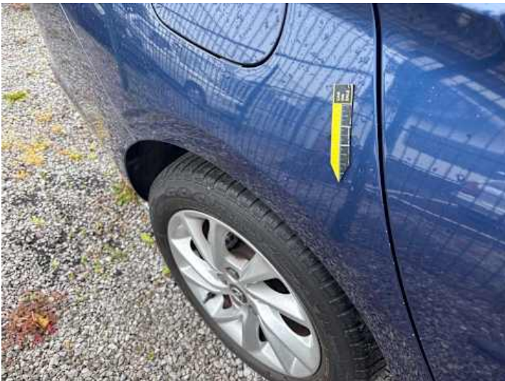
Seitenteil hinten rechts (Delle)
