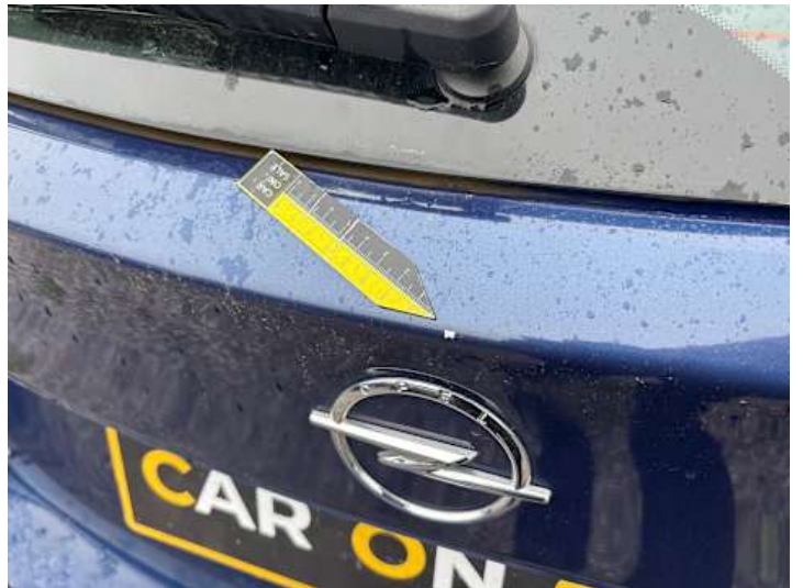
Heckklappe (Kratzer, Lackschaden)
