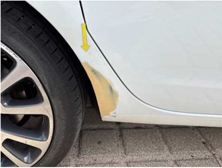
Schweller rechts (Unsachgemäß instand gesetzt)
