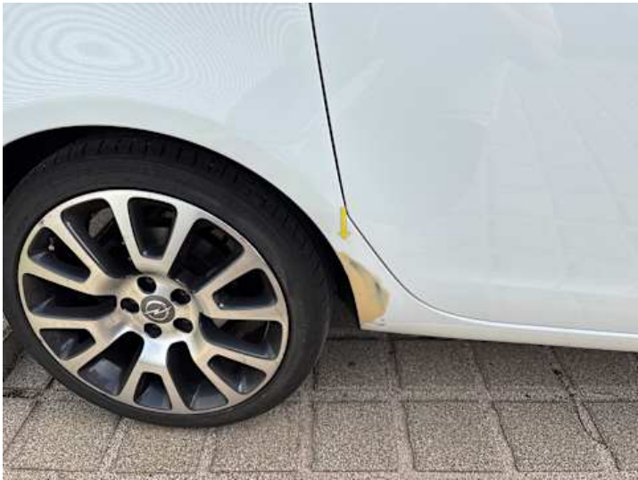
Schweller rechts (Unsachgemäß instand gesetzt)
