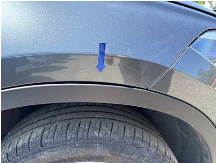
Kotflügel vorne rechts (Spaltmaße ungenau)
