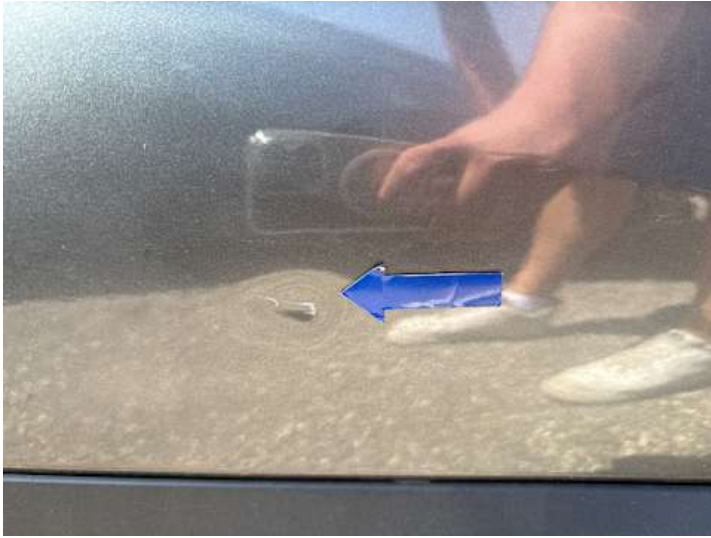
Türe hinten rechts (Delle, Kratzer)
