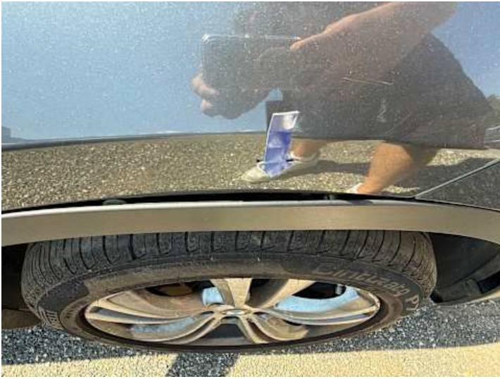
Kotflügel vorne rechts (Spaltmaße ungenau)
