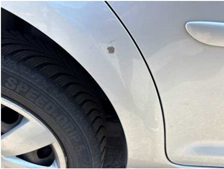
Seitenteil hinten rechts (Steinschlag, Rost)
