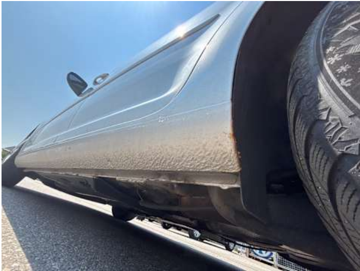
Schweller links (Rost)
