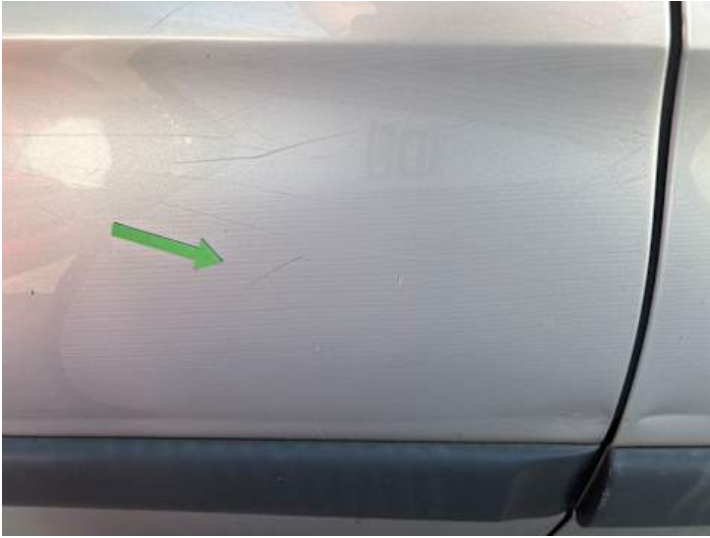
Türe hinten rechts (Delle, Kratzer)
