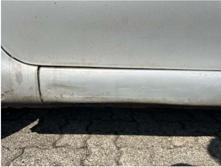
Schweller links (Delle, Unsachgemäß instand gesetzt)
