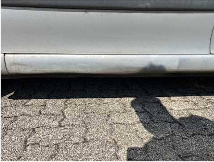
Schweller links (Delle, Unsachgemäß instand gesetzt)
