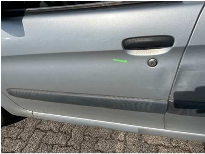
Fahrtür (Delle, Kratzer)
