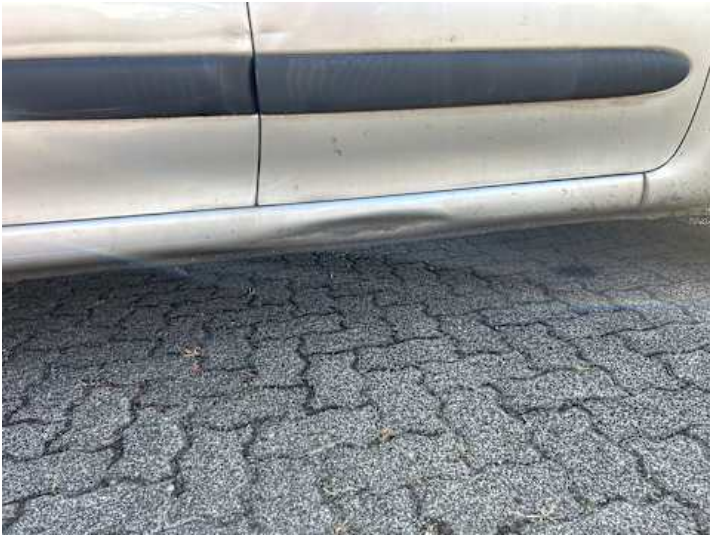
Schweller rechts (Verformung)
