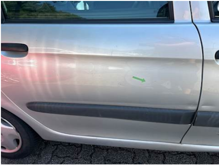
Türe hinten rechts (Delle, Kratzer)
