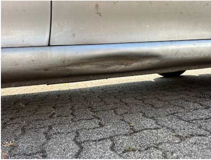
Schweller rechts (Verformung)
