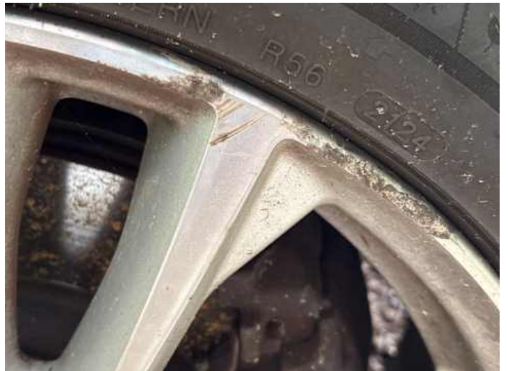
Rad (Kratzer, Kerben, Rost)
