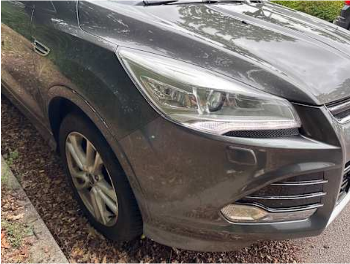
Stoßstange vorne (Lackschaden, Unsachgemäß instand gesetzt)
