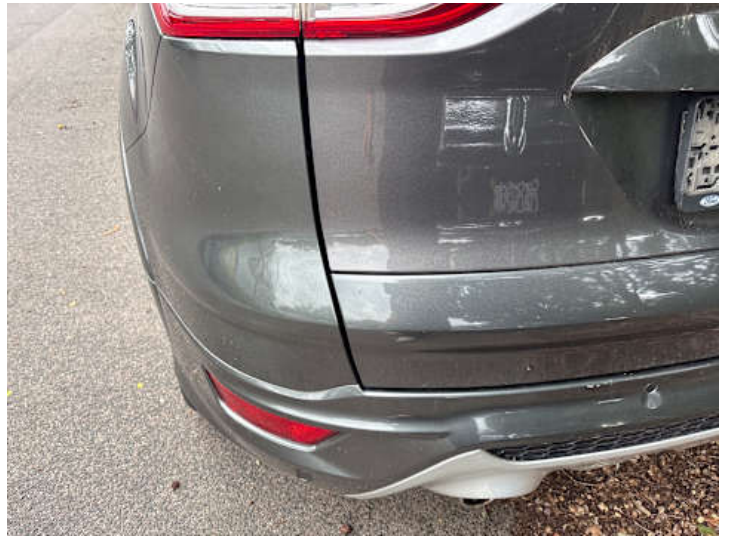
Heckklappe (Lackschaden, Unsachgemäß instand gesetzt)
