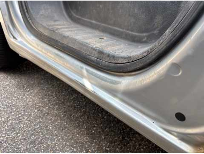
Schweller links (Lackschaden)
