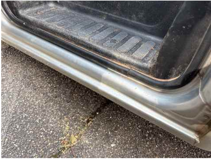
Schweller links (Lackschaden)
