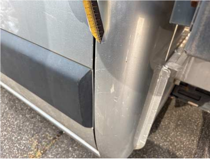
Seitenteil hinten links (Lackschaden, Delle)
