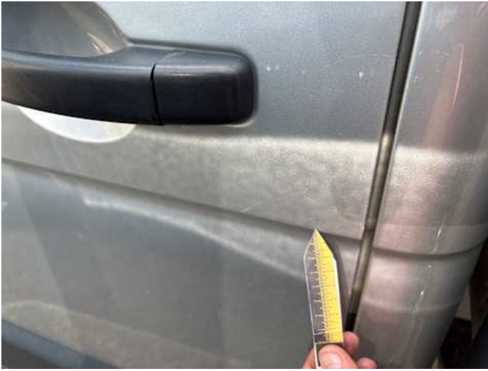
Türe hinten links (Lackschaden)
