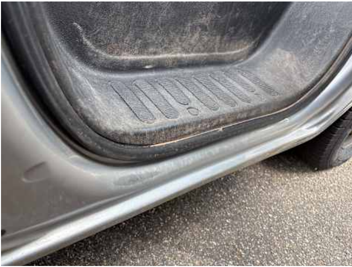
Schweller rechts (Lackschaden)
