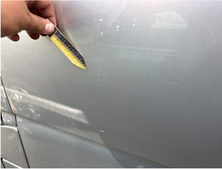
Türe hinten links (Lackschaden)
