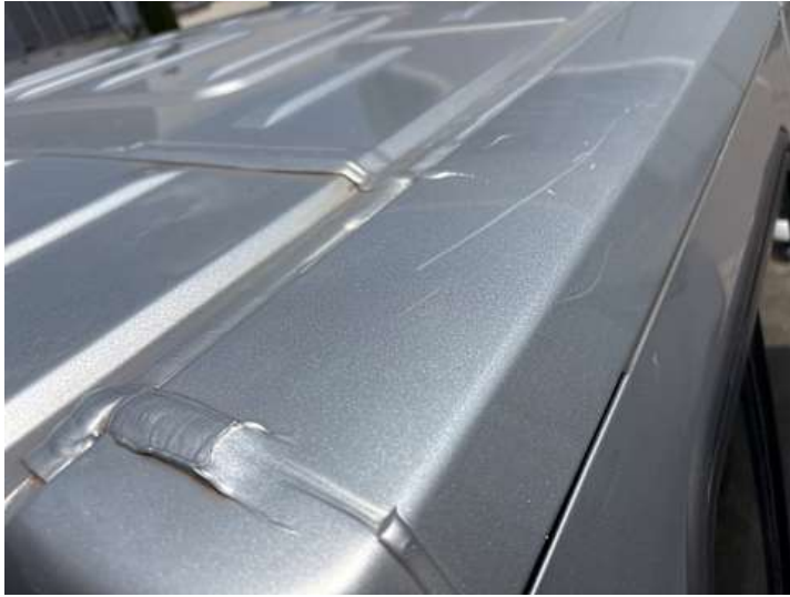
Dach (Lackschaden, Kratzer)
