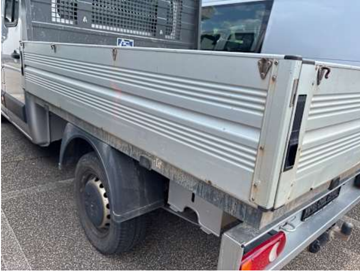
Seitenteil hinten links (Lackschaden, Delle)
