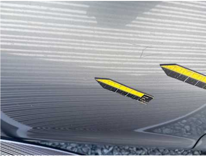
Türe hinten rechts (Delle, Kratzer)
