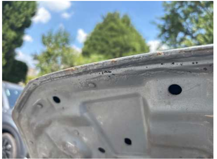
Motorhaube (Lackschaden, Rost)
