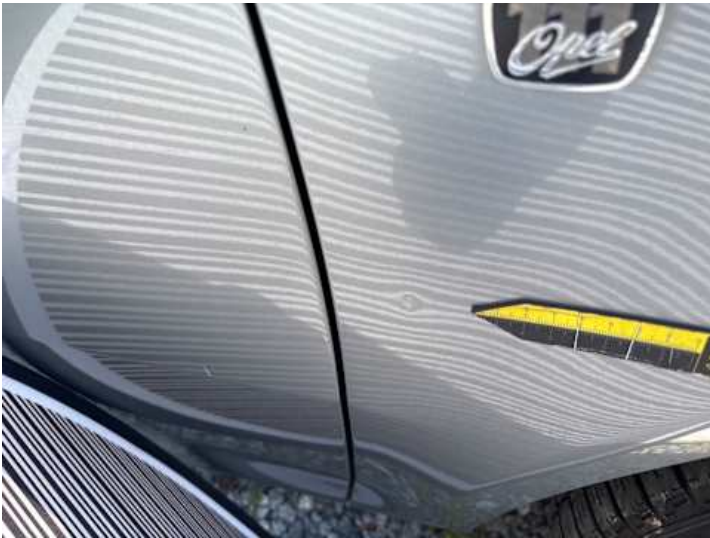
Kotflügel vorne rechts (Delle)
