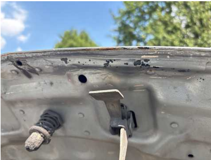
Motorhaube (Lackschaden, Rost)
