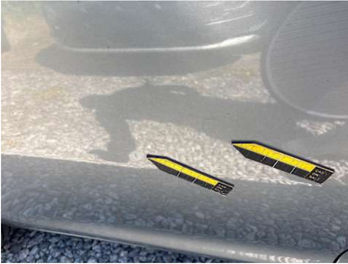
Türe hinten rechts (Delle, Kratzer)
