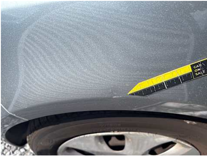
Kotflügel vorne links (Delle, Kratzer)
