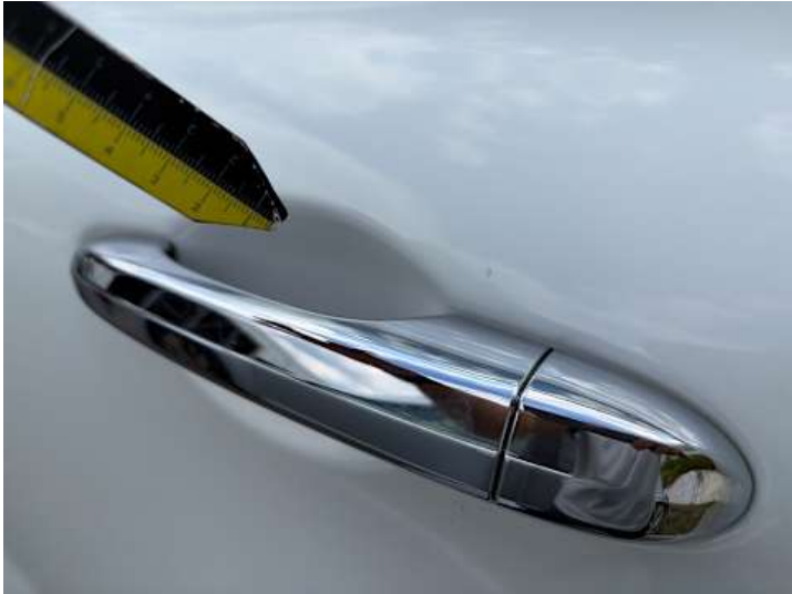
Türe hinten links (Lackschaden, Kratzer)
