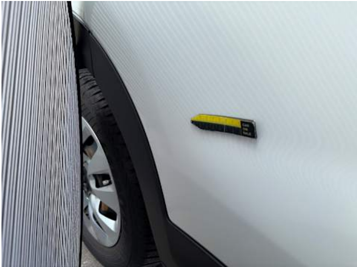
Türe hinten rechts (Delle, Verformung)
