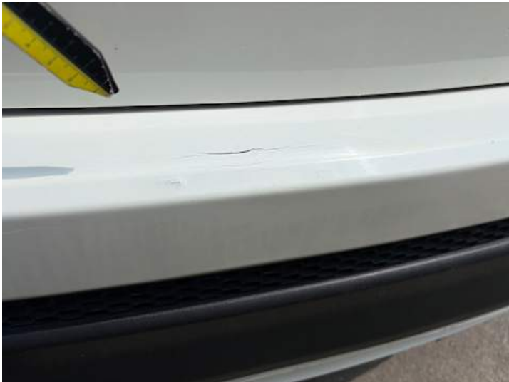
Stoßstange hinten (Riss/Bruch)
