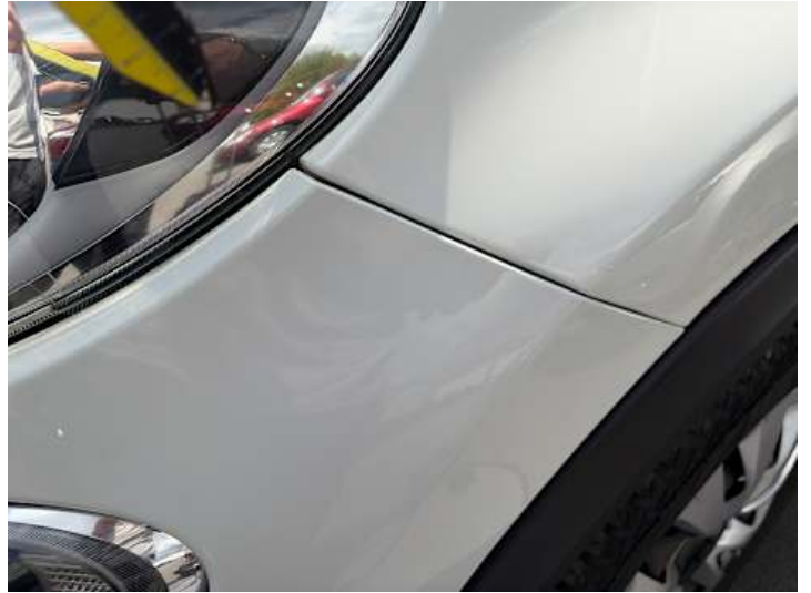
Stoßstange vorne (Spaltmaße ungenau)
