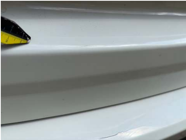
Heckklappe (Lackschaden, Kratzer)
