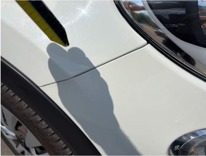
Stoßstange vorne (Spaltmaße ungenau)
