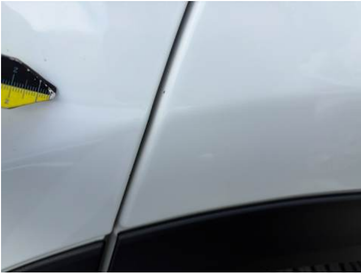
Seitenteil hinten links (Lackschaden, Kratzer)
