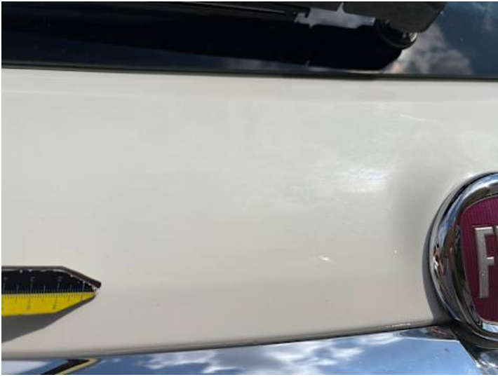
Heckklappe (Lackschaden, Kratzer)
