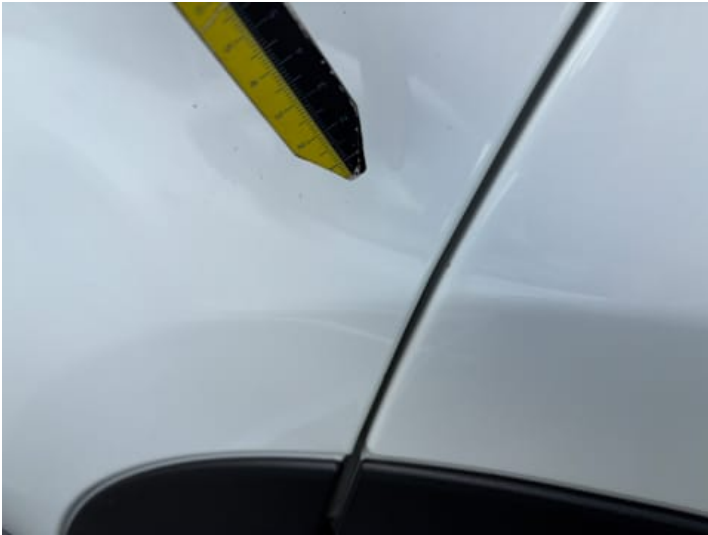
Türe hinten links (Lackschaden, Kratzer)
