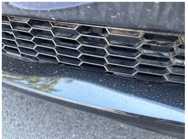
Stoßstange vorne (Riss/Bruch)
