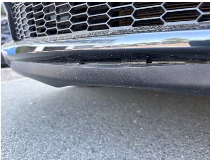
Stoßstange vorne (Riss/Bruch)
