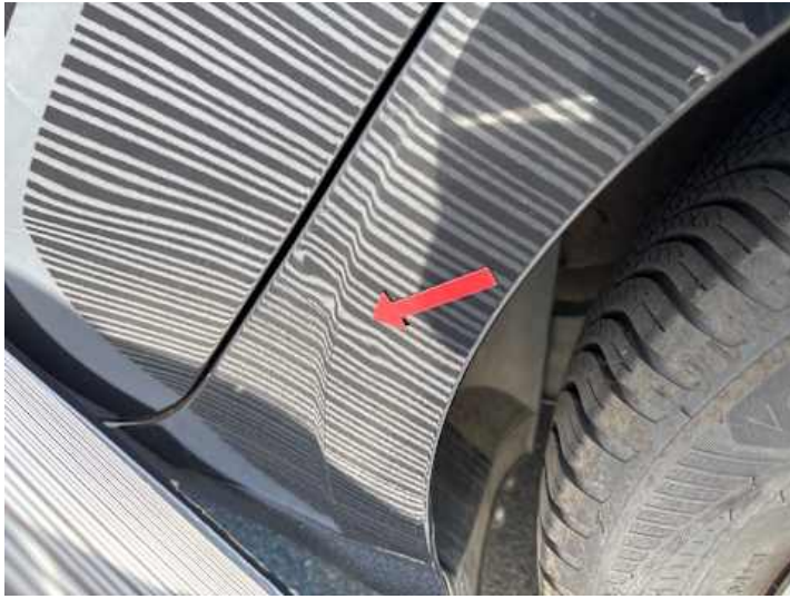
Seitenteil hinten links (Delle)
