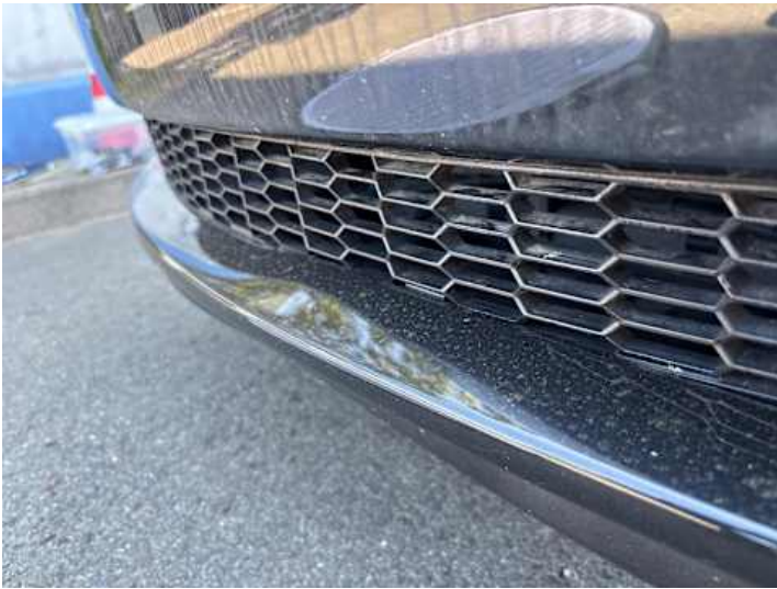
Stoßstange vorne (Verformung)
