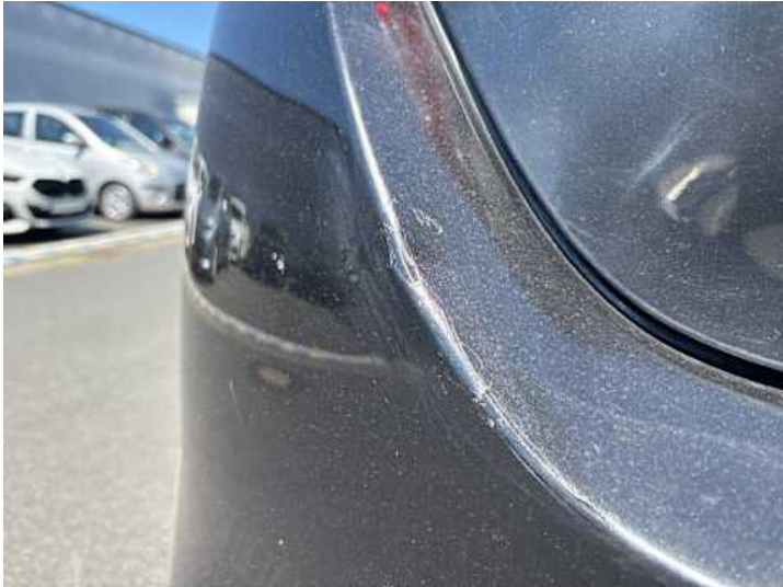
Stoßstange hinten (Lackschaden)
