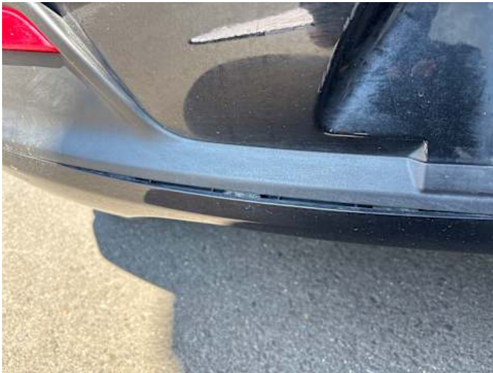
Stoßstange hinten (Spaltmaße ungenau, Riss/Bruch)
