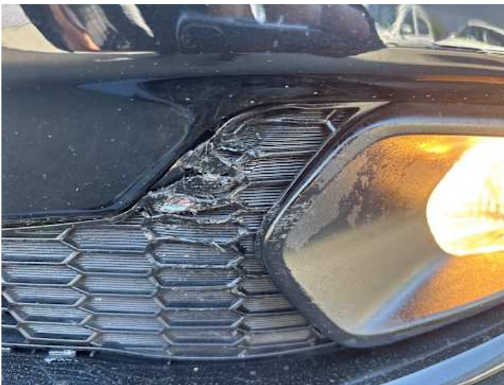
Stoßstange vorne (Riss/Bruch, Kratzer)
