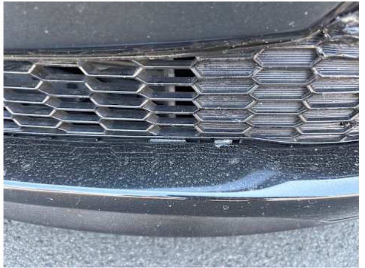
Stoßstange vorne (Riss/Bruch, Kratzer)
