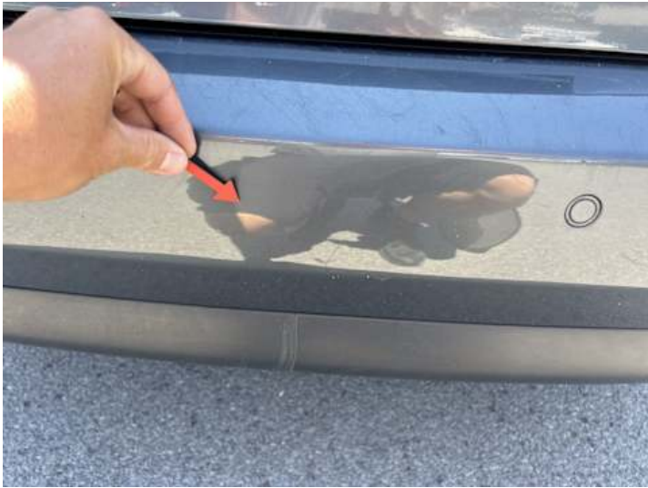
Stoßstange hinten (Kratzer, Verformung)
