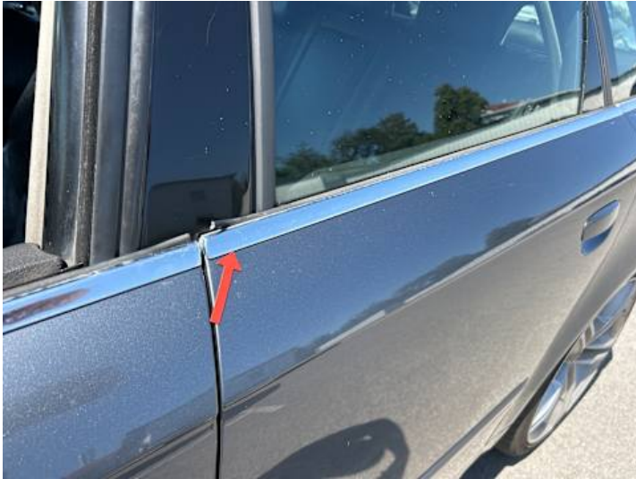
Türe hinten links (Riss/Bruch)
