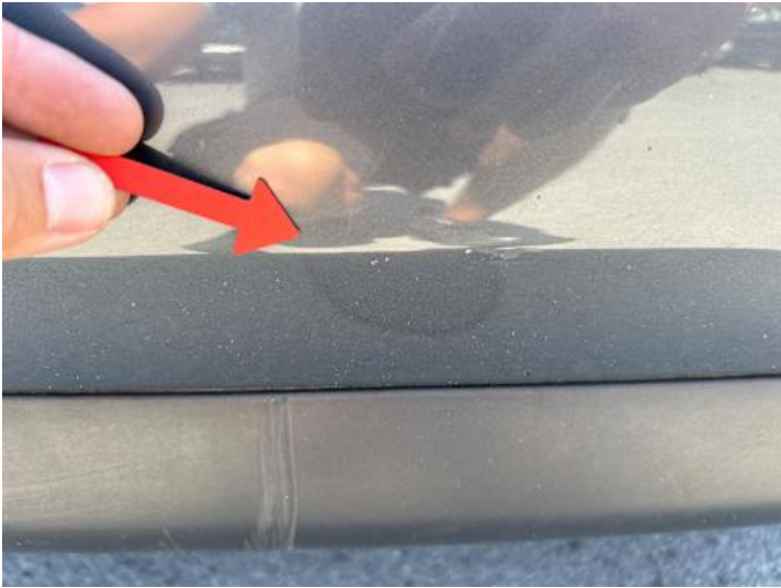
Stoßstange hinten (Kratzer, Verformung)
