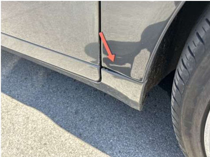
Kotflügel vorne rechts (Spaltmaße ungenau)
