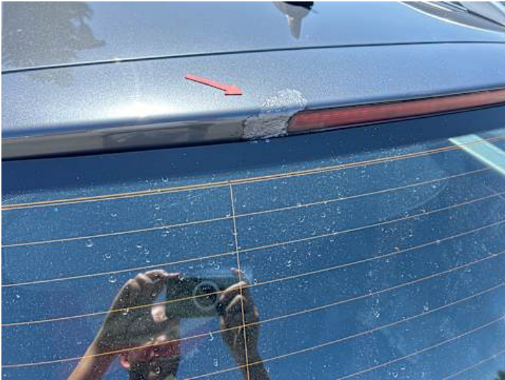
Heckklappe (Rost, Unsachgemäß instand gesetzt)
