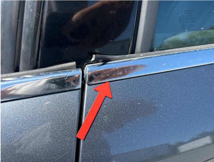
Türe hinten links (Riss/Bruch)
