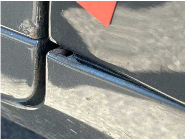
Kotflügel vorne rechts (Spaltmaße ungenau)
