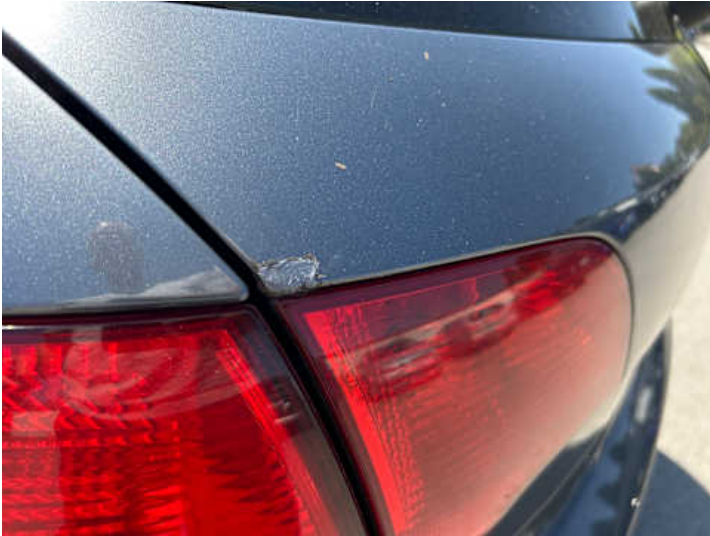
Heckklappe (Rost, Unsachgemäß instand gesetzt)
