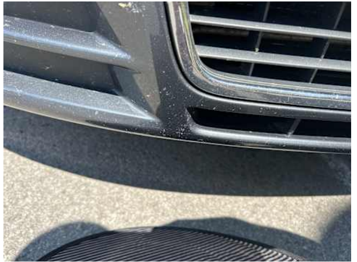
Stoßstange vorne (Verformung)
