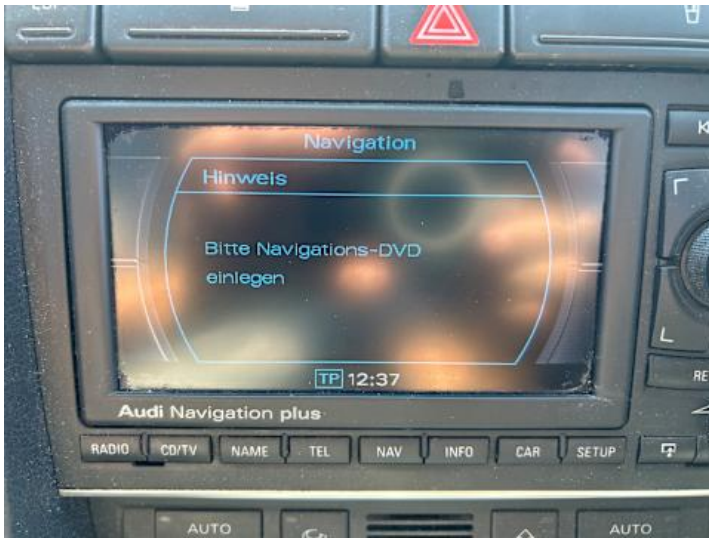
Innenraum (Ohne Funktion, Anderer Schaden): Datenträger fehlt
