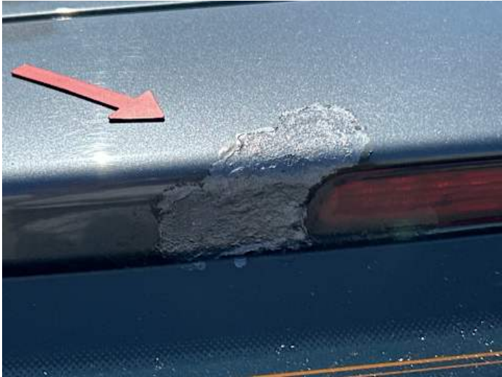
Heckklappe (Rost, Unsachgemäß instand gesetzt)
