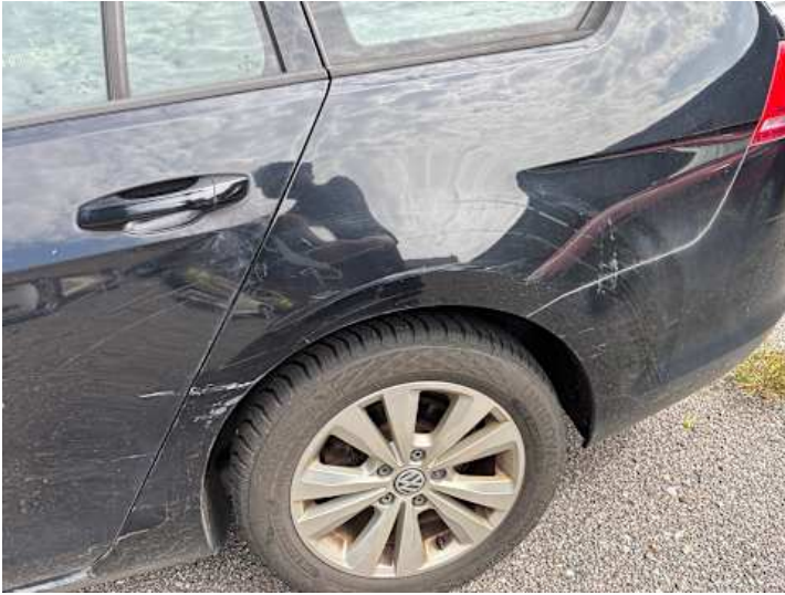
Seitenteil hinten links (Verformung, Kratzer)
