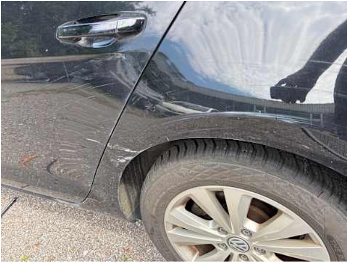
Seitenteil hinten links (Verformung, Kratzer)
