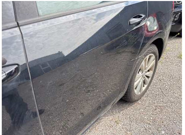
Türe hinten links (Kratzer, Verformung)
