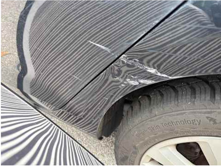
Seitenteil hinten links (Verformung, Kratzer)
