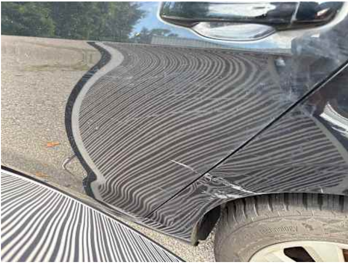
Türe hinten links (Kratzer, Verformung)
