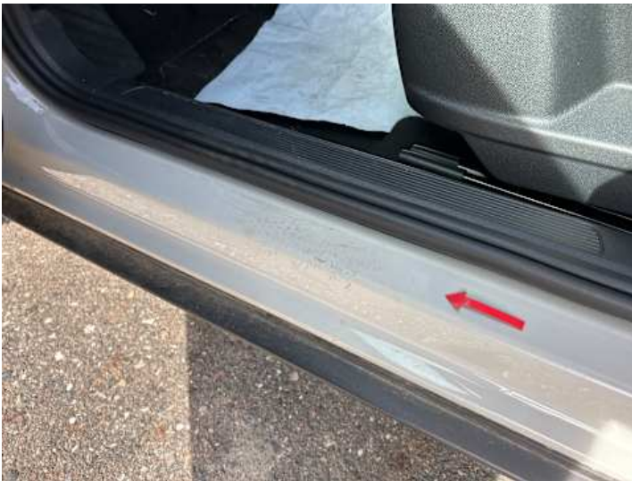
Schweller links (Kratzer)
