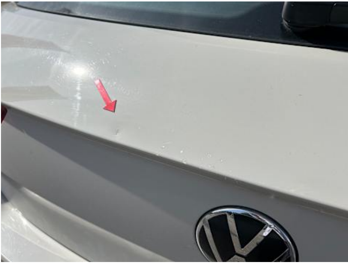
Heckklappe (Delle, Lackschaden)
