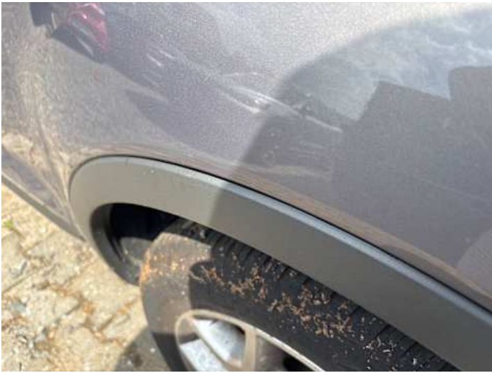
Kotflügel vorne rechts (Spaltmaße ungenau)
