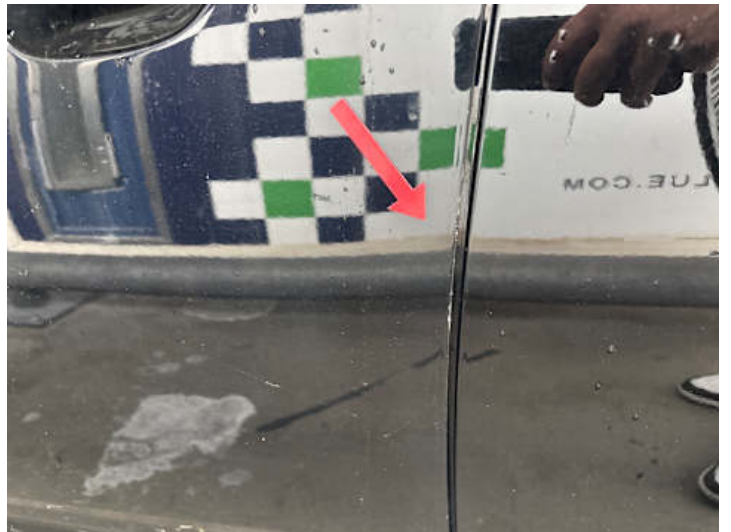
Fahrertür (Kratzer, Spaltmaße ungenau)
