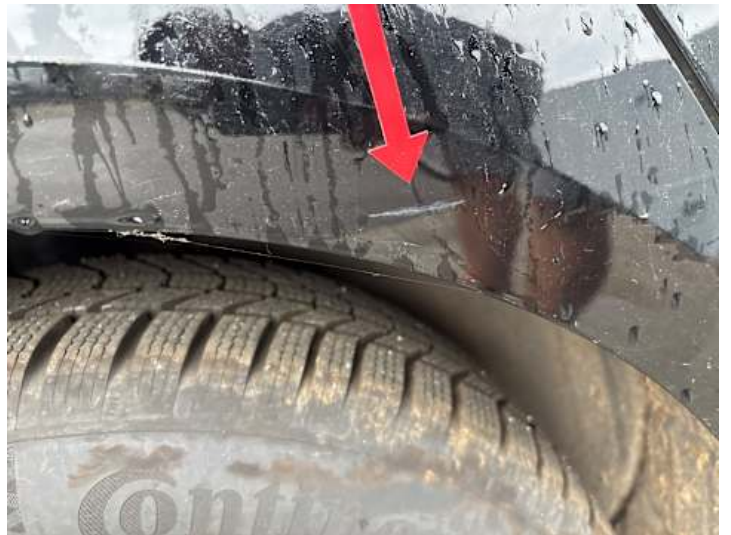
Seitenteil hinten links (Kratzer)
