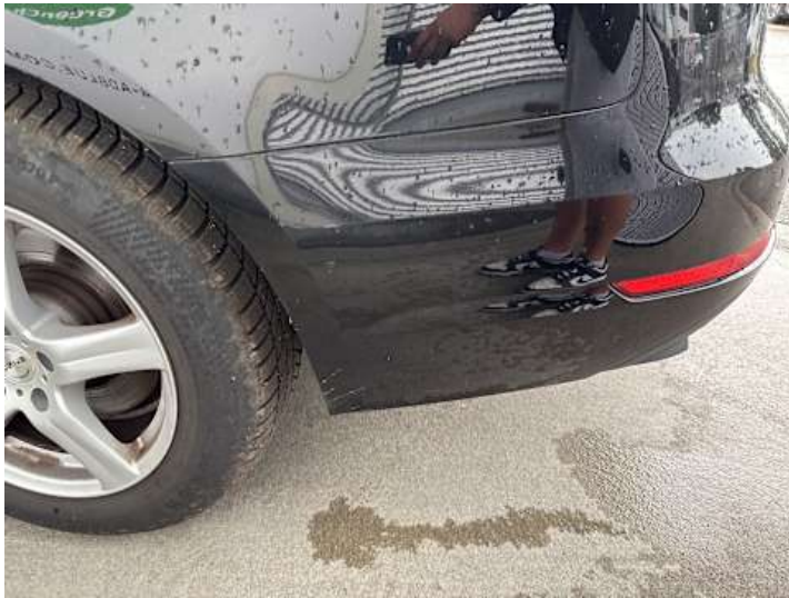
Stoßstange hinten (Kratzer, Lackschaden)
