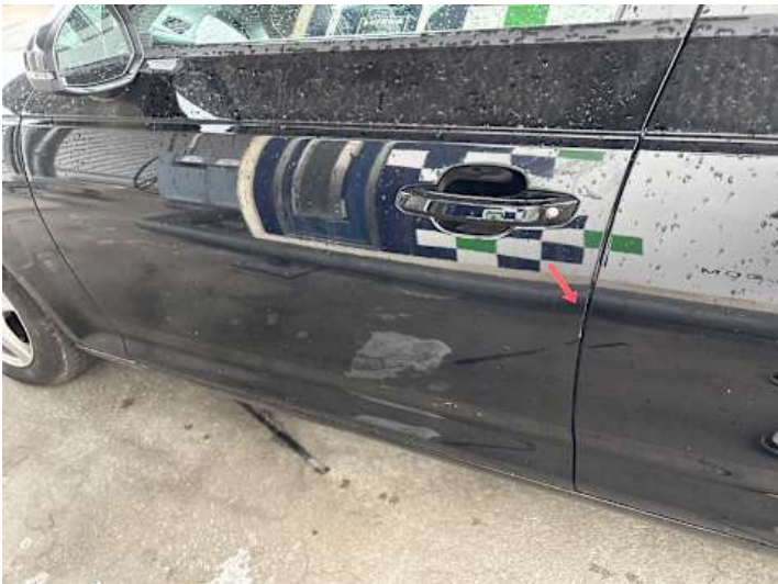
Fahrertür (Kratzer, Spaltmaße ungenau)
