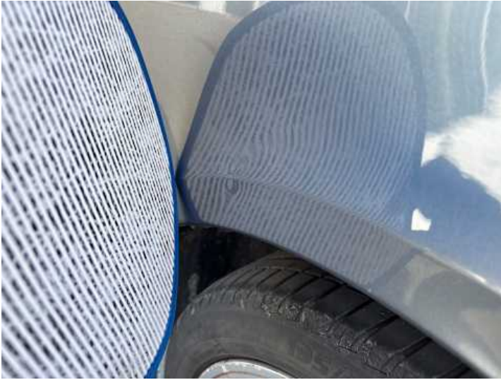
Seitenteil hinten links (Delle)
