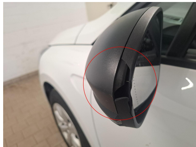
Bild 2: Außen, Außenspiegel links - Gehäuse, zerbrochen, erneuern
