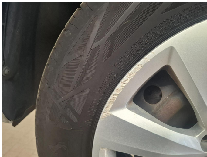
Bild 3: Außen, Felge vorne links - Radzierdeckel, verschrammt, erneuern
