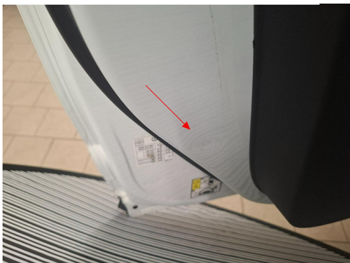
Bild 1: Außen, Tür vorne links - innen, eingedellt, drücken
