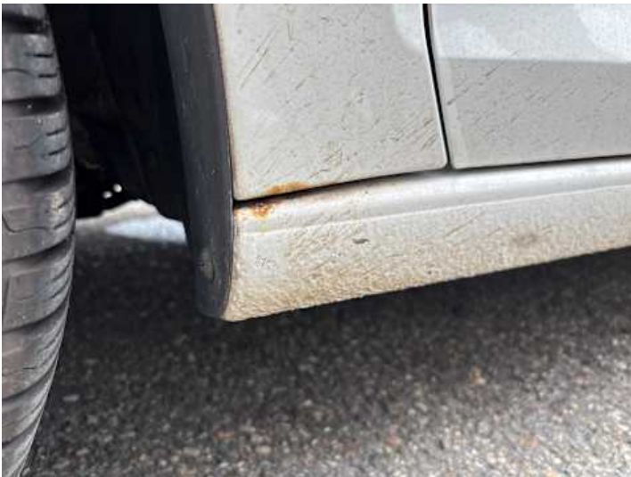
Schweller links (Rost)
