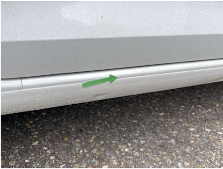
Schweller rechts (Kratzer)
