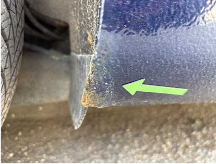
Schweller rechts (Rost)
