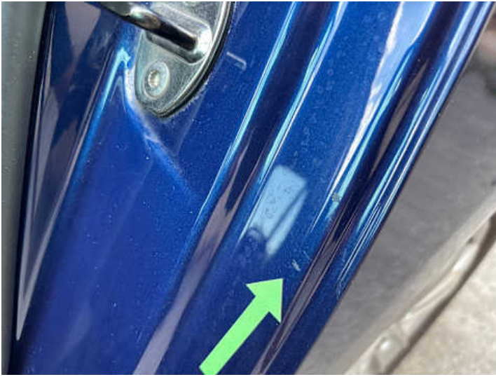
Seitenteil hinten links (Kratzer)
