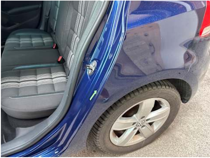
Seitenteil hinten links (Kratzer)
