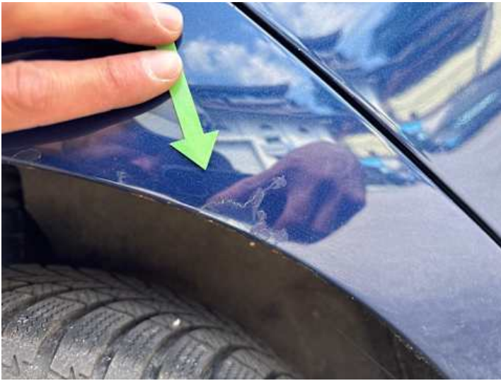
Seitenteil hinten rechts (Lackschaden)
