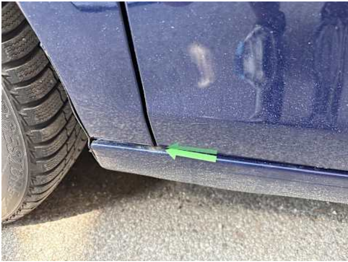
Schweller links (Rost)
