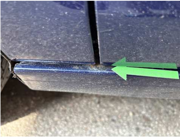
Schweller links (Rost)
