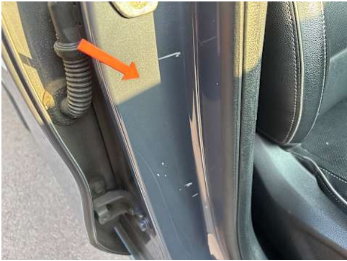
Schweller rechts (Lackschaden, Delle)
