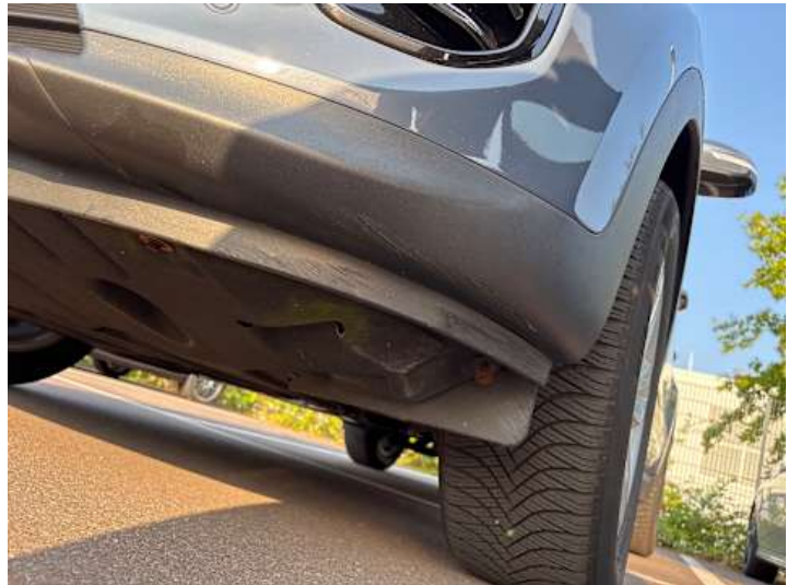
Stoßstange vorne (Riss/Bruch, Kratzer)
