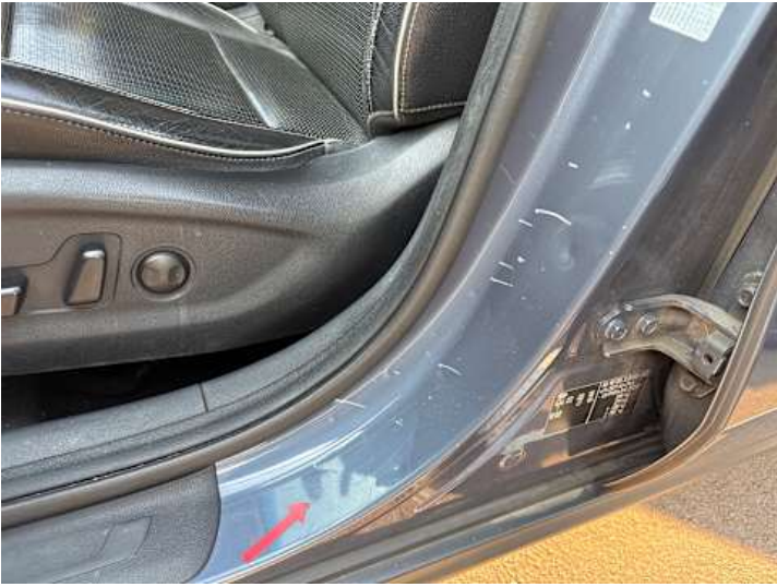
Schweller links (Lackschaden, Delle)
