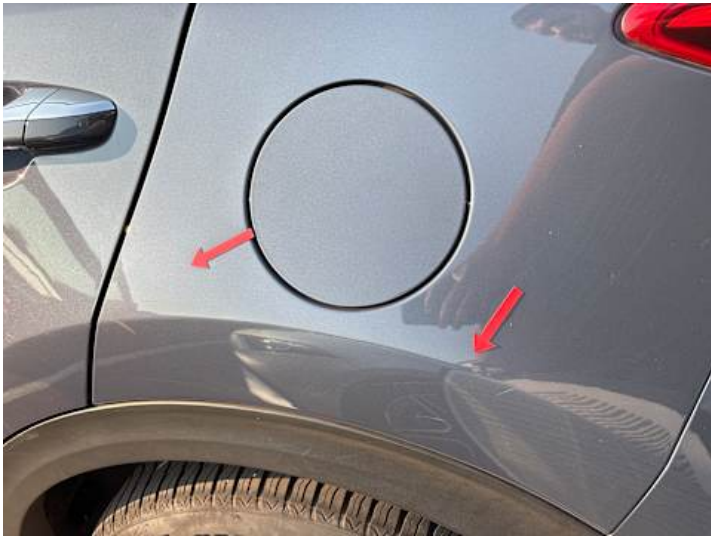
Seitenteil hinten links (Lackschaden, Kratzer)
