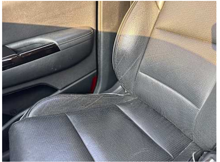
Innenraum (Verschleiß, Kratzer)
