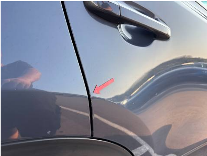
Türe hinten rechts (Lackschaden)
