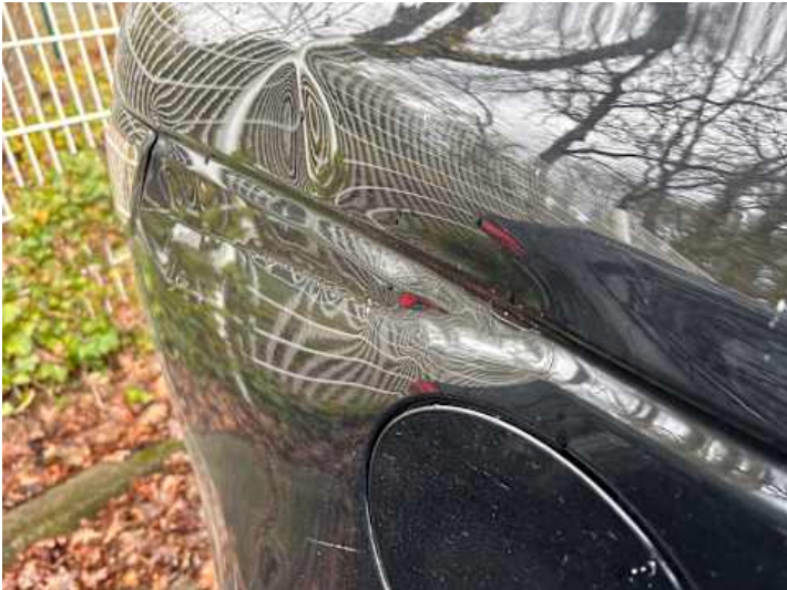
Seitenteil hinten rechts (Verformung, Lackschaden)
