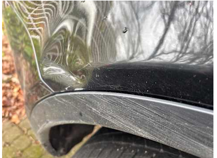
Seitenteil hinten rechts (Verformung, Lackschaden)
