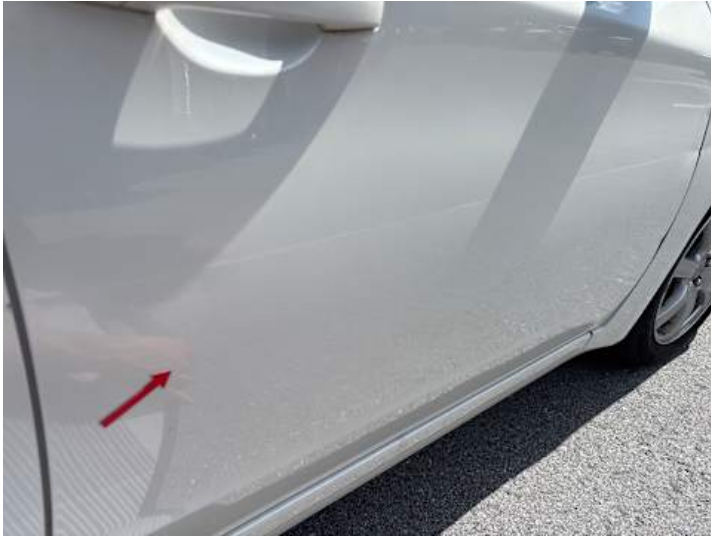
Beifahrertür (Kratzer, Verformung)
