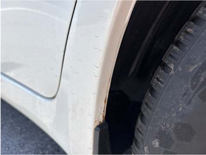
Seitenteil hinten links (Rost)
