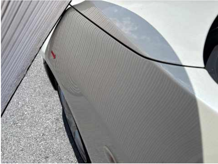
Kotflügel vorne links (Delle)
