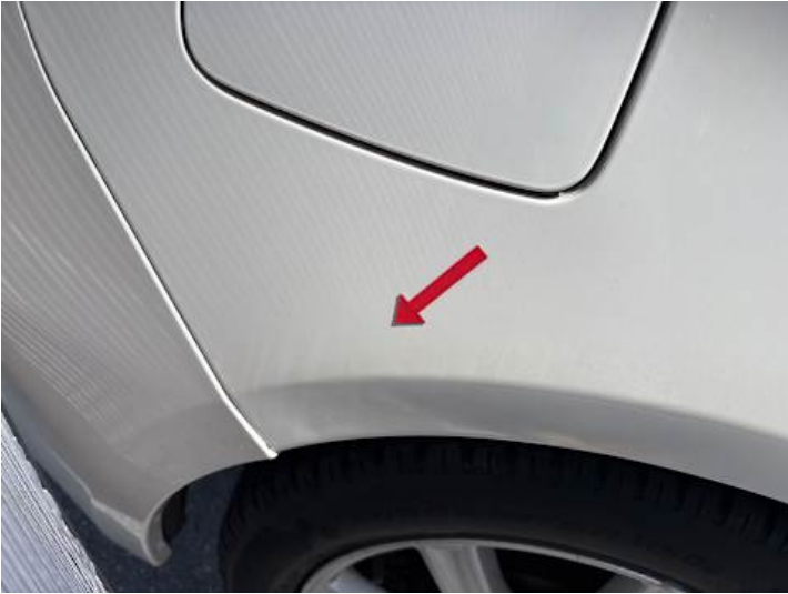
Seitenteil hinten rechts (Verformung, Lackschaden, Unsachgemäß instand gesetzt)
