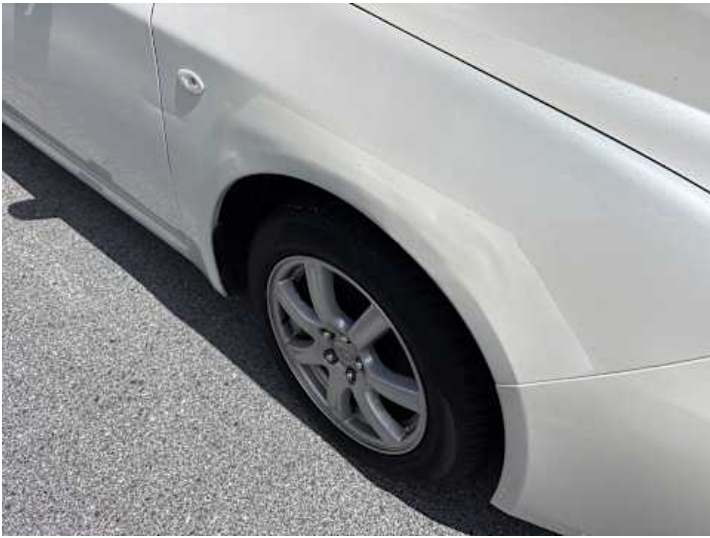
Kotflügel vorne rechts (Lackschaden, Unsachgemäß instand gesetzt, Verformung)
