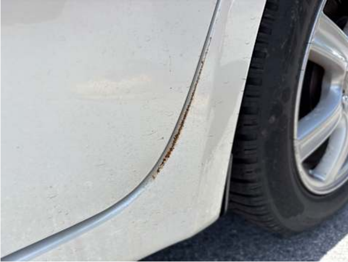
Seitenteil hinten links (Rost)
