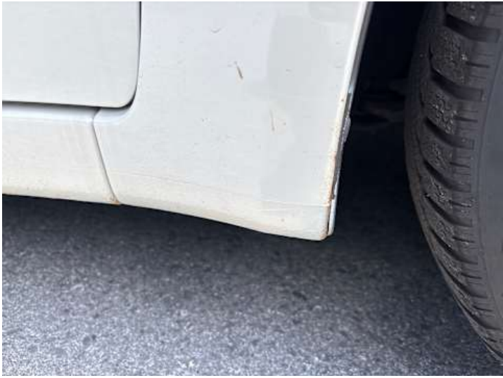
Kotflügel vorne rechts (Rost)
