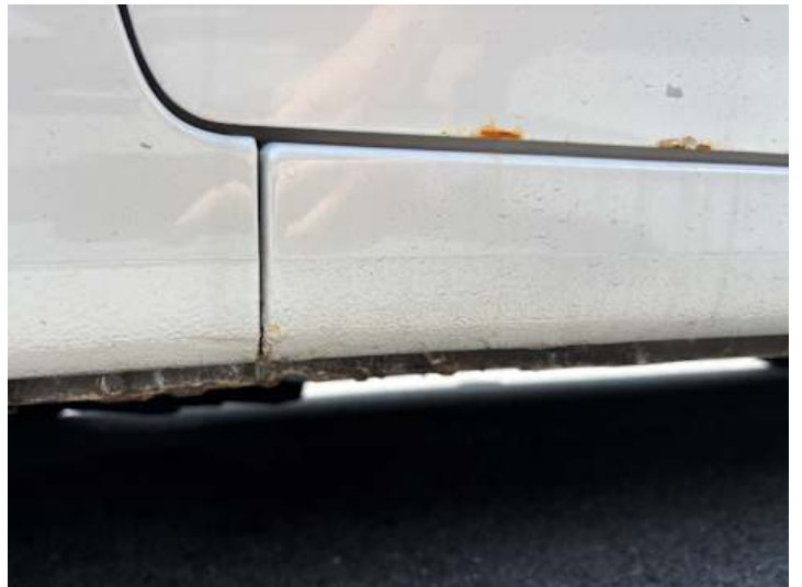
Schweller links (Rost)
