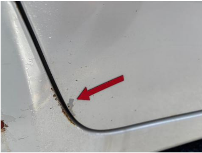
Türe hinten rechts (Rost, Lackschaden)
