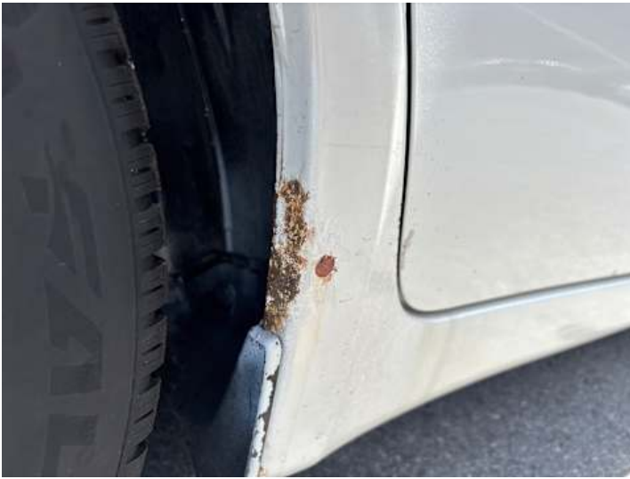
Seitenteil hinten rechts (Rost)
