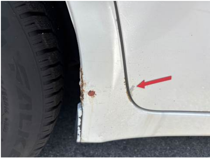
Seitenteil hinten rechts (Rost)
