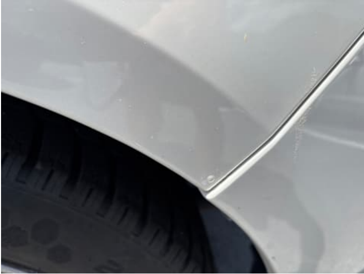
Seitenteil hinten links (Rost)
