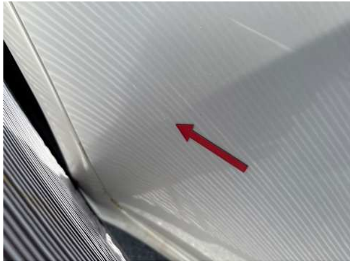
Türe hinten rechts (Delle)
