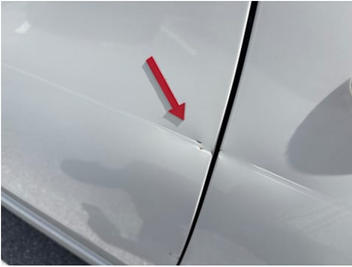
Beifahrertür (Kratzer, Verformung)
