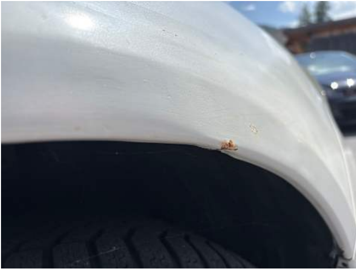
Kotflügel vorne rechts (Rost)
