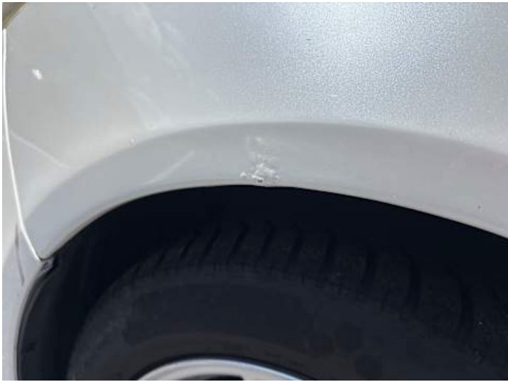
Kotflügel vorne links (Rost)
