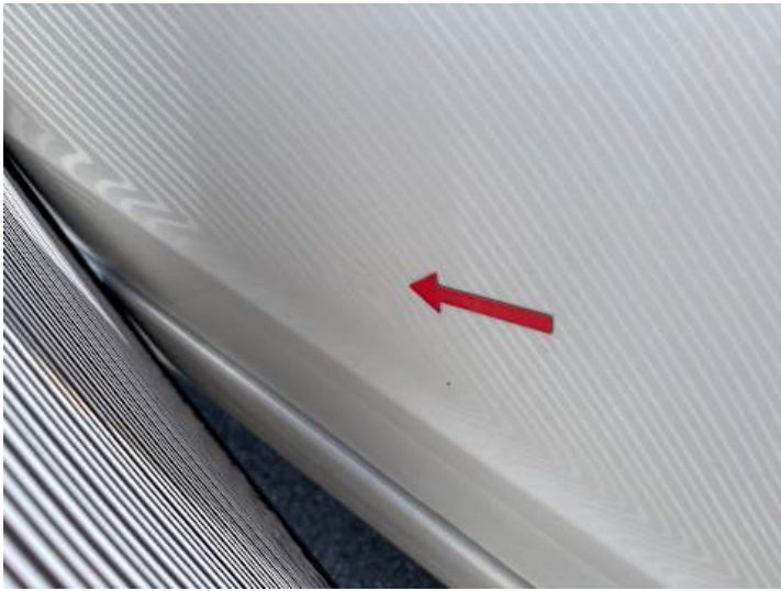
Fahrertür (Delle, Lackschaden)
