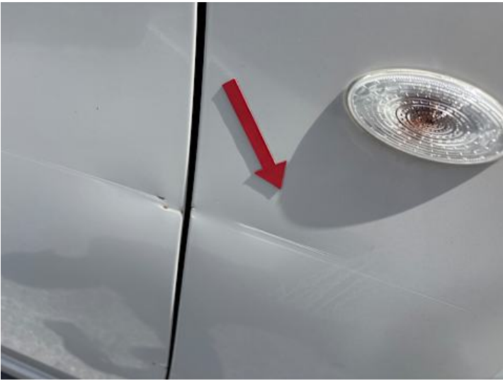
Kotflügel vorne rechts (Kratzer, Verformung)
