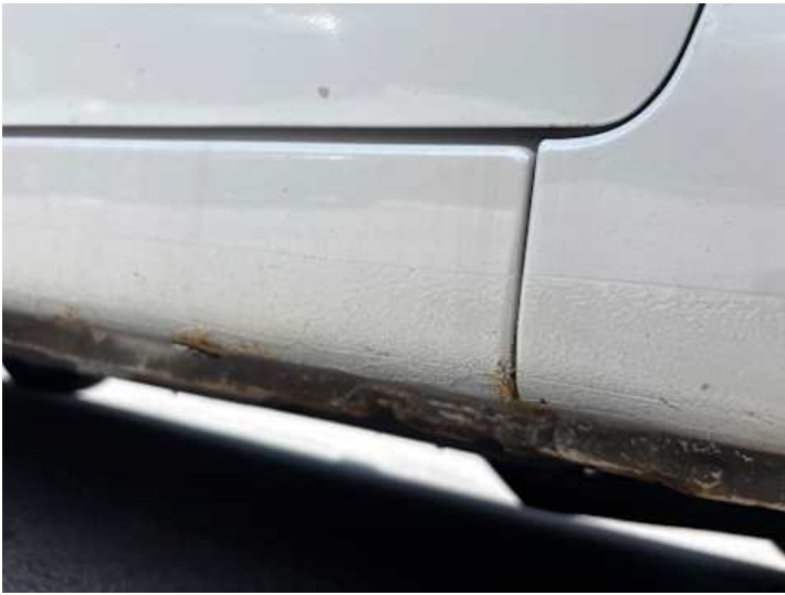
Schweller rechts (Rost)
