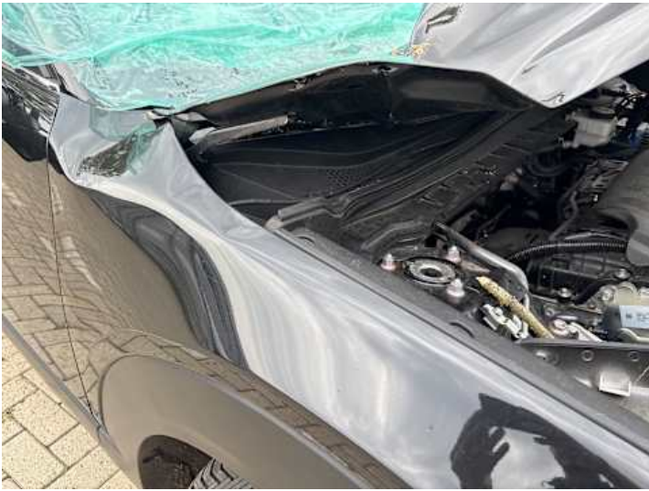
Kotflügel vorne rechts (Kratzer, Delle, Verformung)
