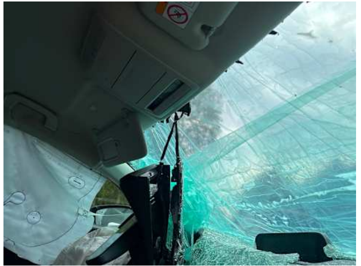
Innenraum (Riss/Bruch, Airbag offen)
