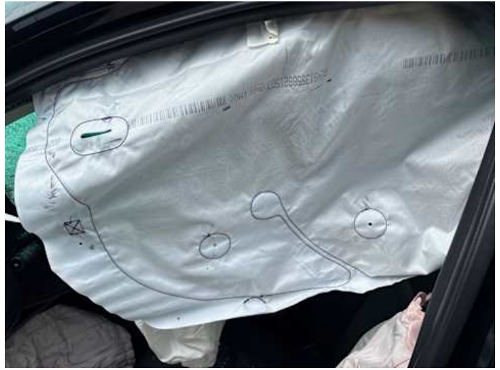
Innenraum (Riss/Bruch, Airbag offen)
