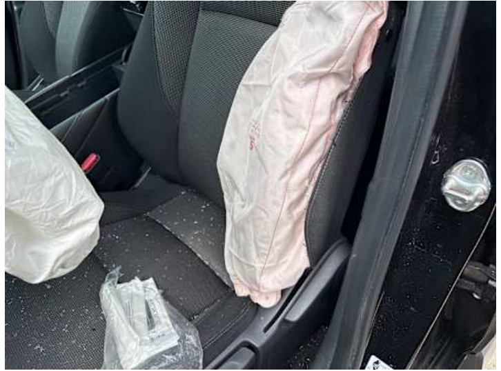
Innenraum (Riss/Bruch, Airbag offen)
