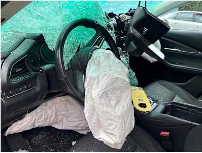
Innenraum (Riss/Bruch, Airbag offen)
