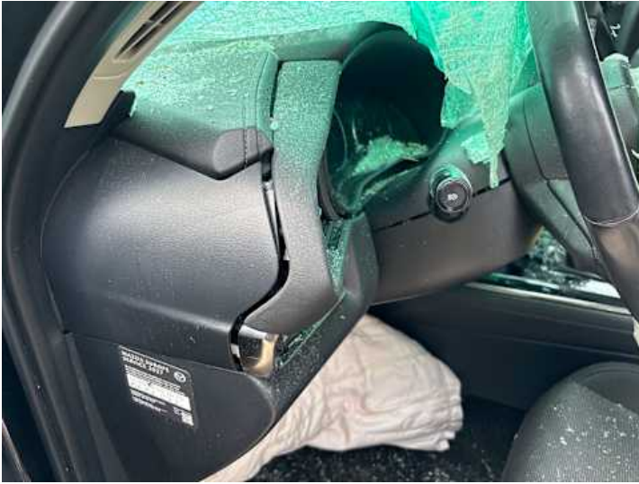
Innenraum (Riss/Bruch, Airbag offen)
