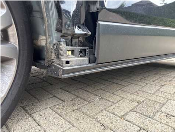
Schweller links (Riss/Bruch)
