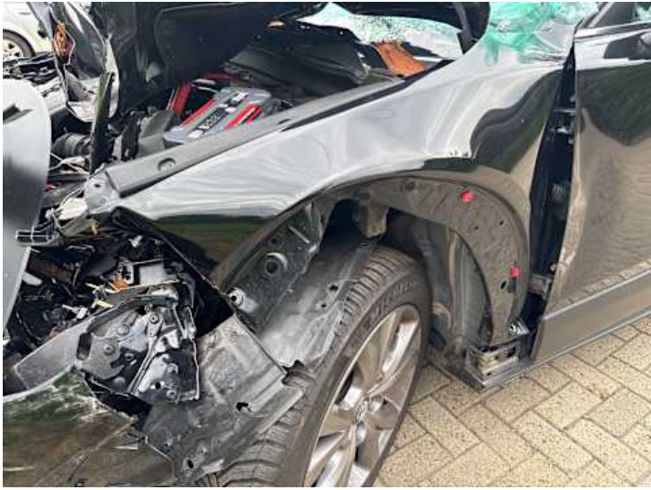
Kotflügel vorne links (Verformung)
