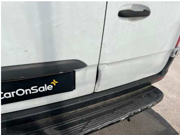
Heckklappe (Verformung, Kratzer)
