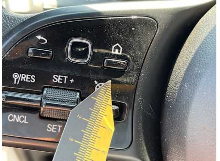
Innenraum (Anderer Schaden): Taste klemmt
