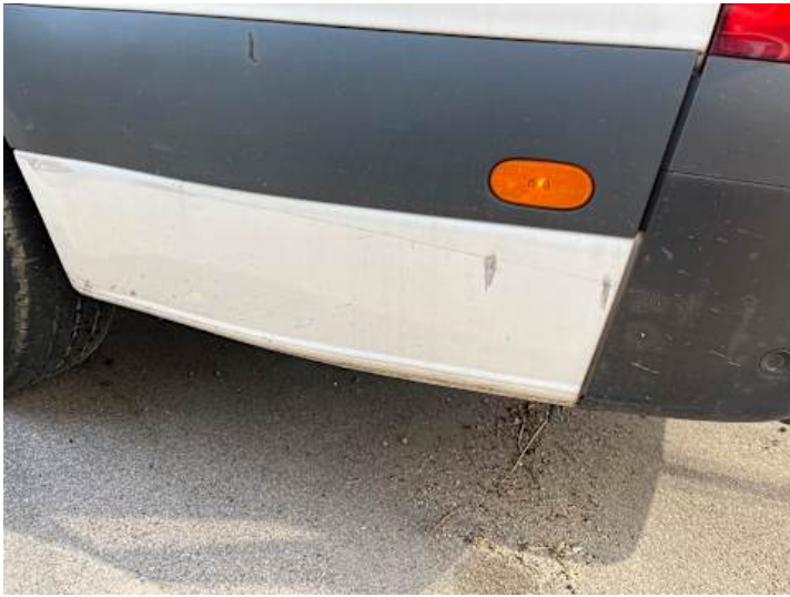
Seitenteil hinten links (Kratzer, Verformung)
