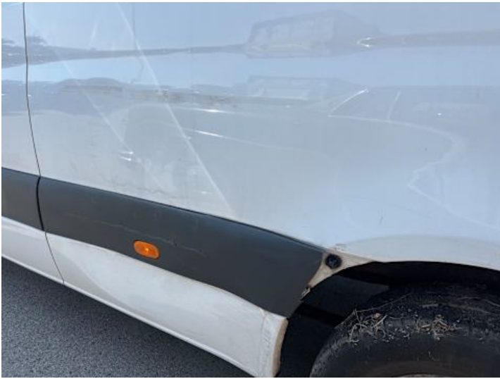
Seitenteil hinten links (Kratzer, Verformung)
