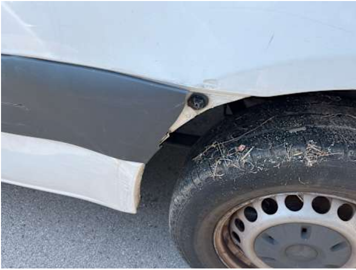
Seitenteil hinten links (Riss/Bruch)
