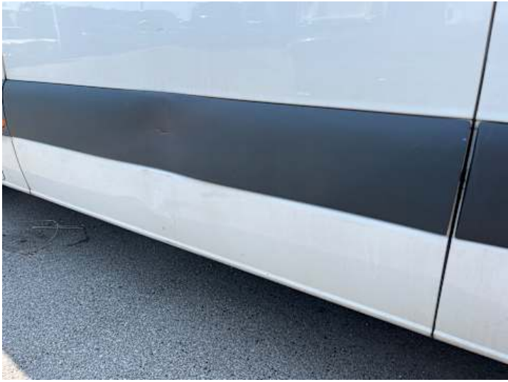
Seitenteil hinten links (Kratzer, Verformung)
